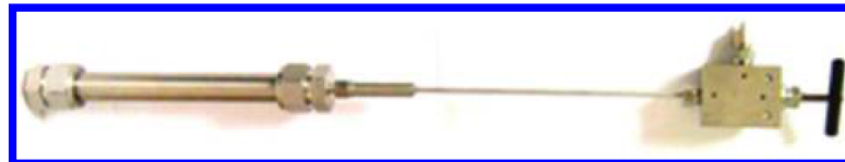
Abbildung 4: Ein 31ml Batch-Reaktor aus Edelstahl mit Swagelok-System (Duan und Savage 2011)
