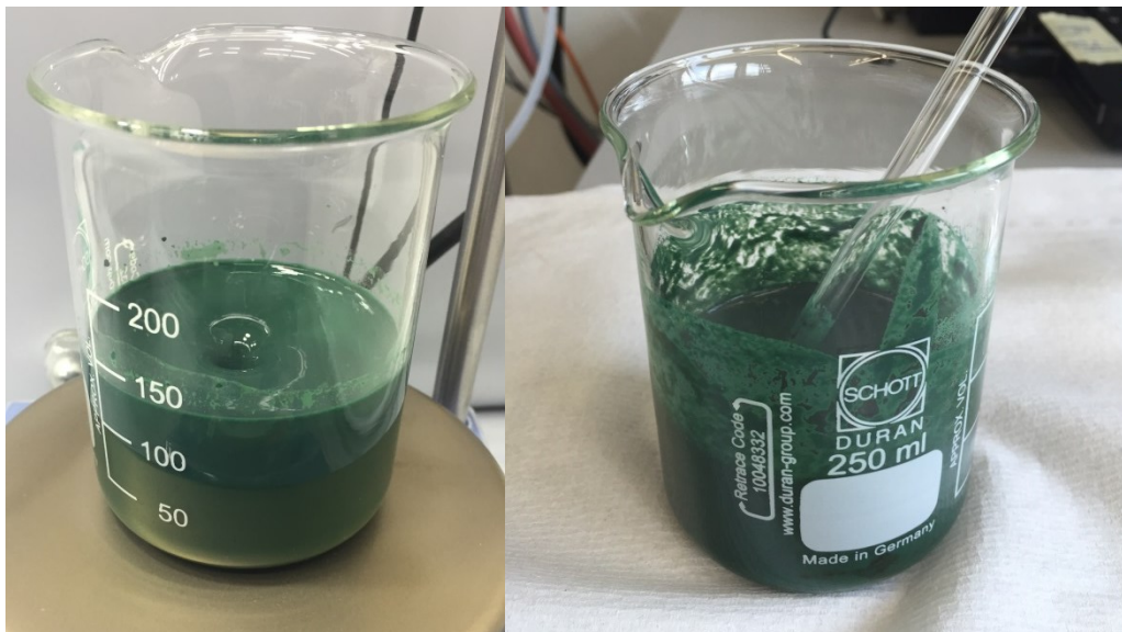
Abbildung 31: Homogenisieren der Suspension mittels Magnetrührer (links) bzw. mittels Glasstab (rechts)
