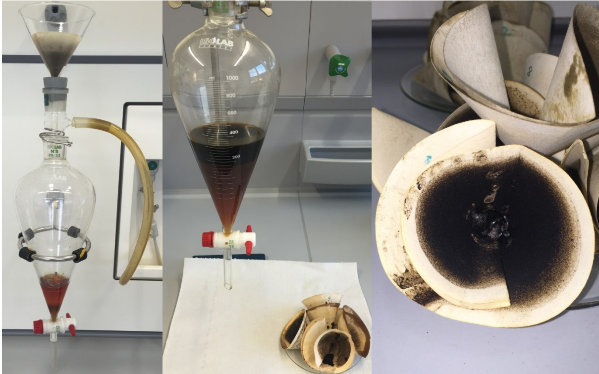
Abbildung 38: Vakuumfiltrationsaufbau mit Scheidetrichter und Wasserstrahlpumpe (links und Mitte); Rückstände am Filterpapier (rechts)
