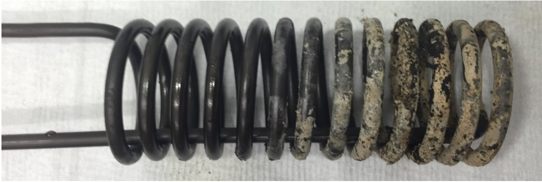
Abbildung 46: Anhaftendes Produkt-Katalysatoren-Gemisch an der Kühlspirale bei Versuch 05C
