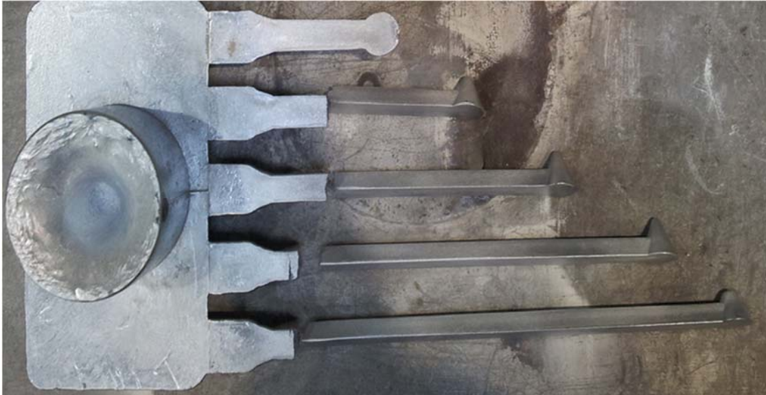
Abbildung 2.21: Abguss der Fingerkokille von einer AA 6061.4 Legierung zur Bestimmung der Warmrissneigung
