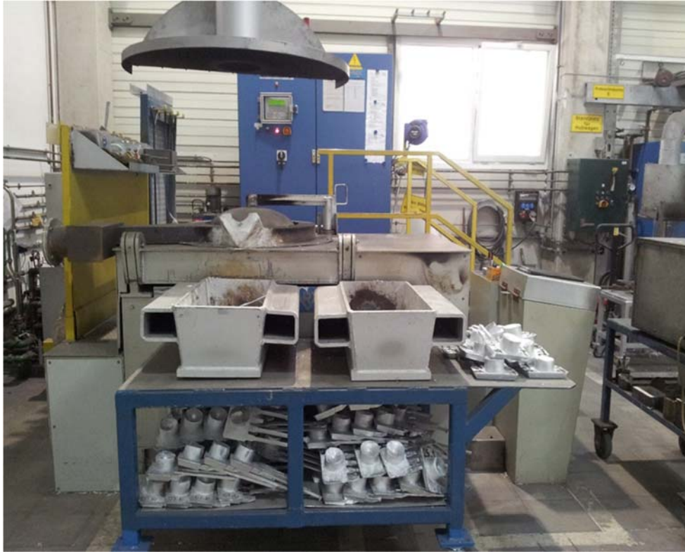
Abbildung 3.3: Schmelzofen und Abgüsse der Fingerkokille
