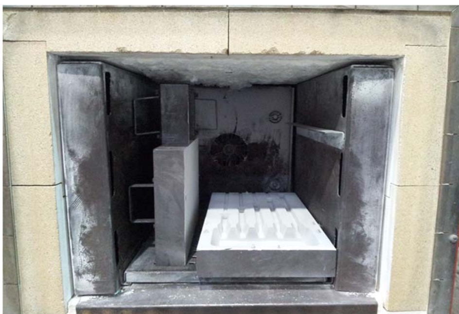
Abbildung 3.2: Vorwärmen der Fingerkokille in dem Luftkammerofen
