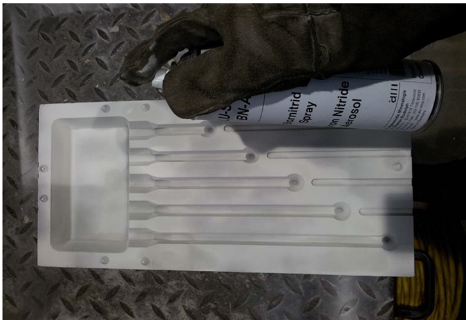
Abbildung 3.1: Vorbereiten der Fingerkokille mithilfe des Bornitrid-Sprays
