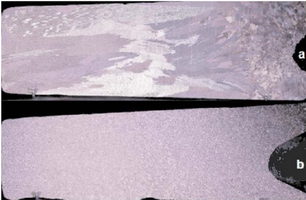
Abbildung 2.14: a) Ohne Kornfeinung, b) Kornstruktur der Legierung AA 3004 nach der Zugabe von 10 ppm B ( Al_5Ti_1B Legierung) [30]
