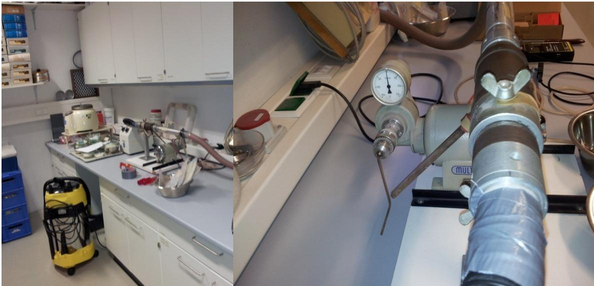
Abbildung 42: Absaugung mit Pulsationsvorrichtung
