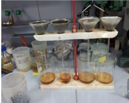
Abbildung 22: Schwimm-Sink Analyse mit  $\text{Na}(\text{WO}_4)_x$  Lösung
