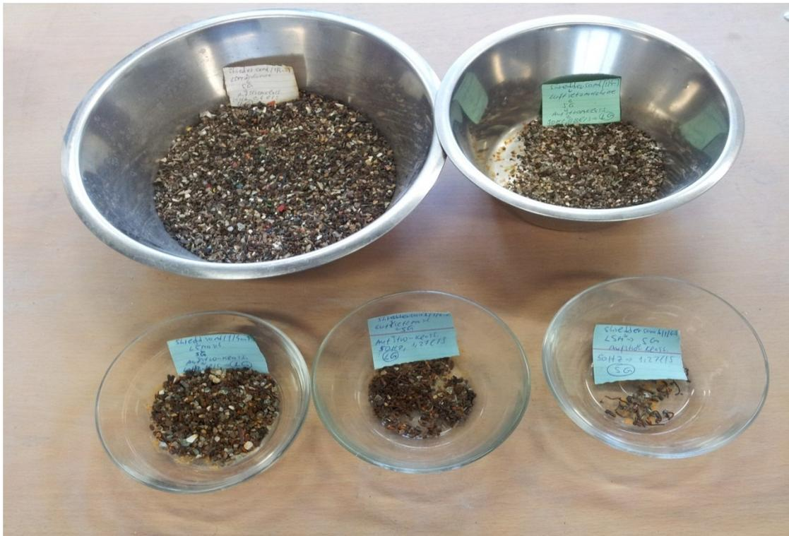
Abbildung 45: Produkte aus dem Aufstromklassierversuch
