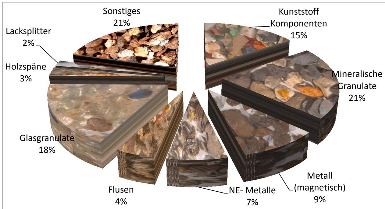
Abbildung 21: Shreddersand (4/2 mm) - Prozentueller Massenanteil alle Stoffe
