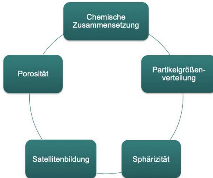
Abb. 4: Wichtige Eigenschaftsmerkmale der Ti-Pulver für die additive Fertigung [9,10].
