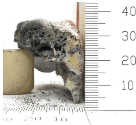
Abbildung 2-13: Stark poröse Krustenprobe.
