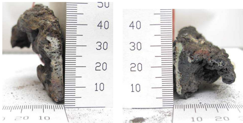
Abbildung 4-2: Krustenproben der BKV 3; Non-Sinus-Muster (links) und Sinus-Muster (rechts).
