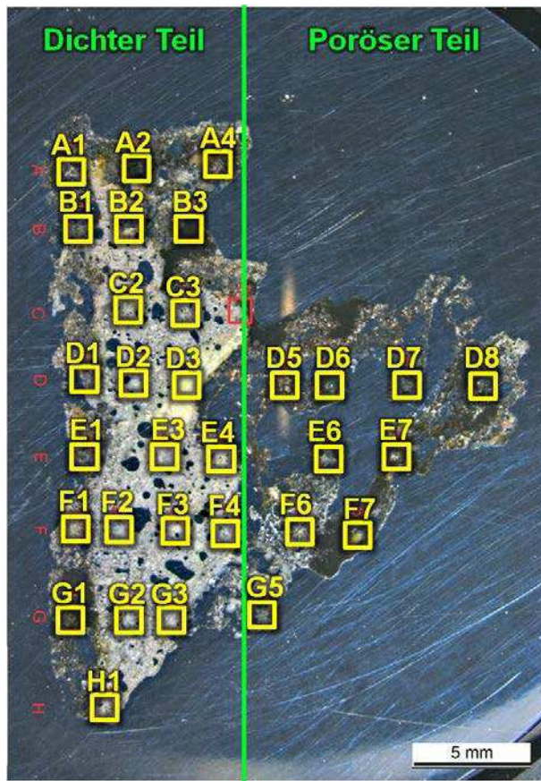
Abbildung 5-9: Untersuchungsstellen (links) und Phasenverteilung (rechts) der Probe "163".
