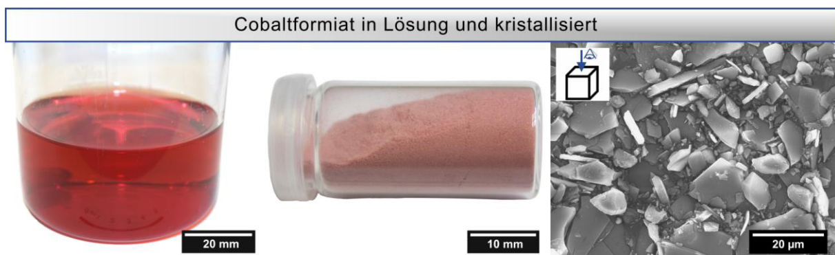
Abbildung 5.34: Erste gewonnene Lösung nach 27 d Laugung (links) und kristallisiertes Cobaltformiat (mittig) sowie Aufnahme des Salzes im REM-SE
