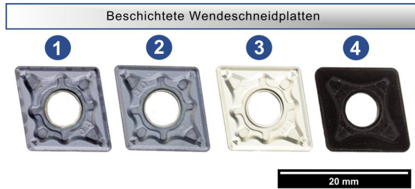
Abbildung 5.37: Verwendete Substrate mit den verschiedenen Beschichtungen für die Tastversuche [101]
