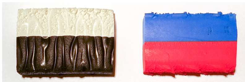
Abbildung 9.7: Coextrudierte Kautschukmischungen für die Visualisierung der Strömungen im Schneckenkanal. (links) CSM, (rechts) EPDM.
