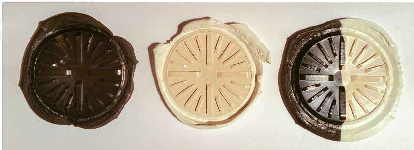
Abbildung 11.2: Proben nach der Charakterisierung der komplexen Viskosit\u00e4t am RPA. (links) schwarze Komponente, (Mitte) wei\u00dfe Komponente, (rechts) 50 % Kombination aus der schwarzen und wei\u00dfen Komponente.
