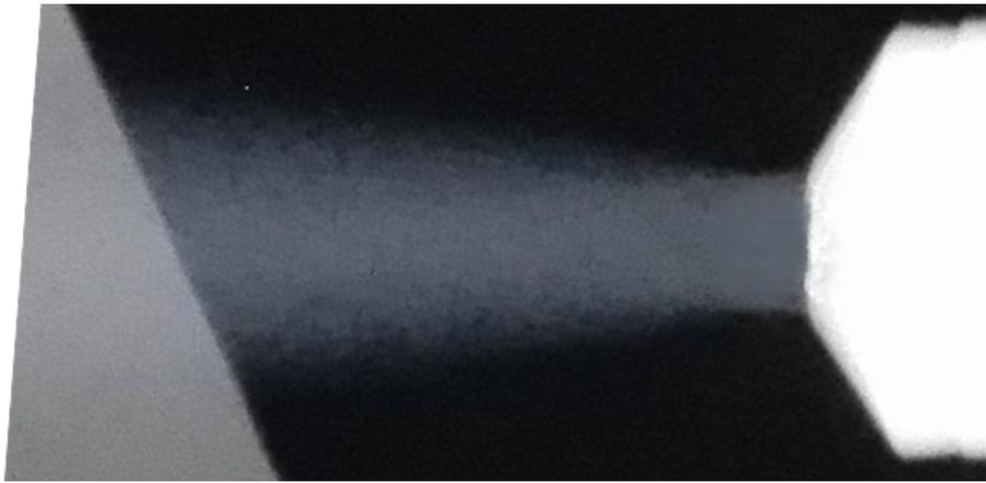
Abbildung 3.12: Gasdüse mit rotationssymmetrischem Freistrah
