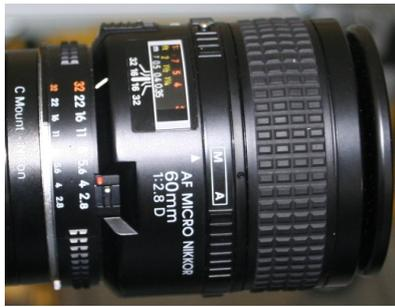
(a) Objektiv 60; Brennweite 60 mm, Lichtstärke 1 : 2,8; kleinste Blende 1 : 32; max. Abbildungsmaßstab 1 : 1, Naheinstellgrenze 219 mm.
