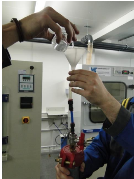
Abbildung 33: Füllprozedere der Rohrsysteme
