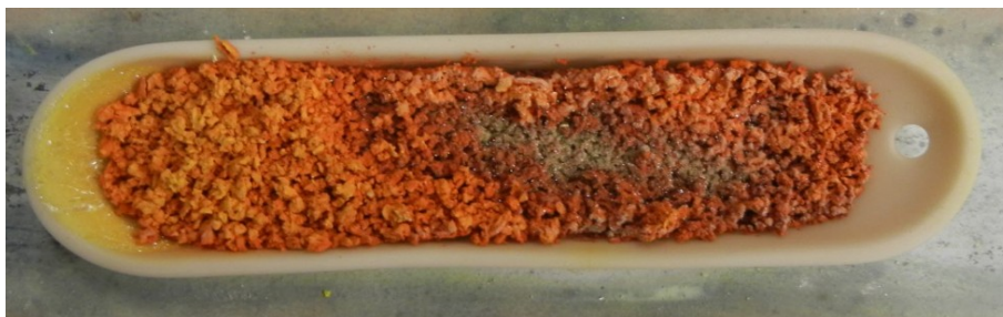
Abbildung 11: Zusammengesinterte Mo-W-Körner am Ende des Versuchs 4
