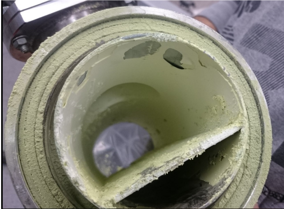
Abbildung 27: Resublimiertes Molybdänoxid im Bereich der Rohmaterialzufuhr
