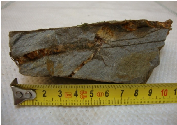
Abbildung 124: Sekundär gebildete aktinolithische Hornblende und Quarz als Klufffüllung, teilweise sind auch Erzphasen (?Magnetkies) vorhanden, PR 351, siehe Kartenbeilage 1.
