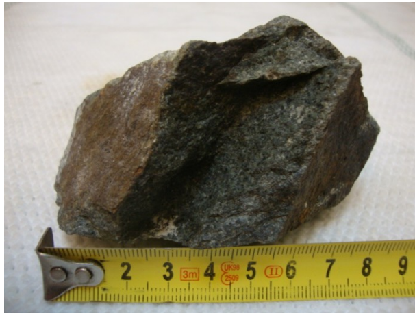
Abbildung 125: Grobkörniges, massig ausgebildetes Gesteinsgefüge mit einem dunkelgrünen Farbeindruck, PR 156, siehe Kartenbeilage 1.
