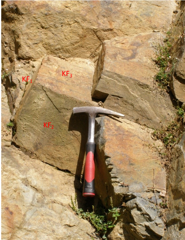
Abbildung 79: Klufflächensystem mit 3 unterschiedlichen Orientierungen im Diabas, KF_1 321/68, KF_2 216/68, KF_3 115/57, Aufschlusspunkt 353, siehe Kartenbeilage 1.
