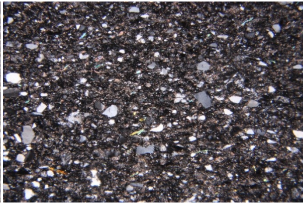
Abbildung 262: Vorwiegend Quarzkomponenten, sehr untergeordnet auch Helglimmer (Muskovite) und Feldpäte (Plagioklase), gekreuzte Polarisatoren, VH1/01, lfm. 5,20, Bildbreite: 4 mm.
