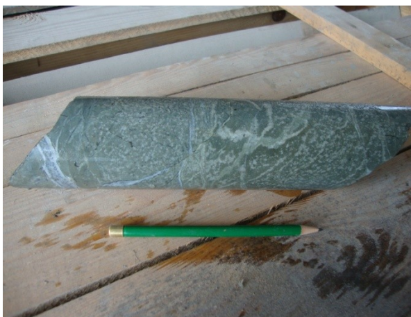
Abbildung 143: Massig ausgebildeter, grüner Diabas mit hellen Feldspat-„Flecken“, VH4/01, lfm. 97,00.
