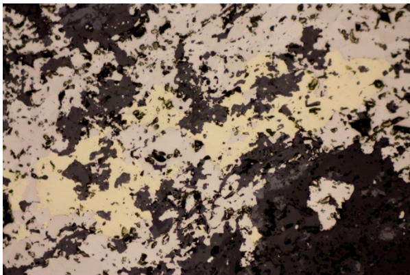
Abbildung 195: Engräumige Verwachsungen zwischen Magnetkies (braune Reflexionsfarbe) und Kupferkies (hellgelbe Reflexionsfarbe), VH6A/01, lfm. 35,15, Bildbreite: 0,5 mm.
