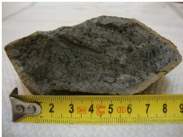
Abbildung 104: Fein- bis mittelkörniges Gefüge mit dunklen, porphyrischen Pyroxenen, PR 343, siehe Kartenbeilage 1.
