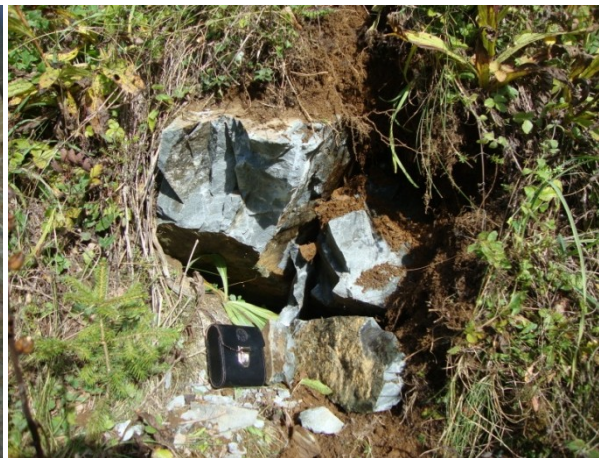
Abbildung 294: Frisch hergestellte Bruchfläche im massigen Diabas beim Herausbrechen von wenig verwittertem/unverwittertem Probenmaterial, Aufschlusspunkt 303, siehe Kartenbeilage 1
