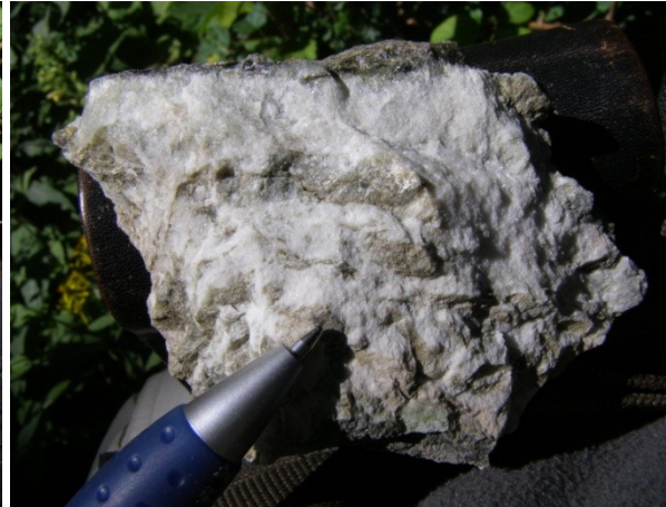
Abbildung 41: Detailaufnahme einer feinkörnig rekristallisierten Kalzitklufffüllung, Aufschlusspunkt 163, siehe Kartenbeilage 1.
