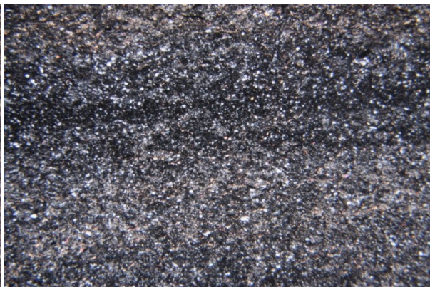
Abbildung 264: Innerhalb der feinkörnigen, quarzreichen Partie ist eine leichte Schichtung erkennbar (dunkle, erzeiche Lagen), gekreuzte Polarisatoren, VH1/01, lfm. 5,20, Bildbreite: 4 mm.
