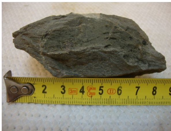
Abbildung 105: Fein- bis mittelkörniges Gefüge mit teilweise dunklen Chlorit-„Schlieren“, PR 127, siehe Kartenbeilage 1.
