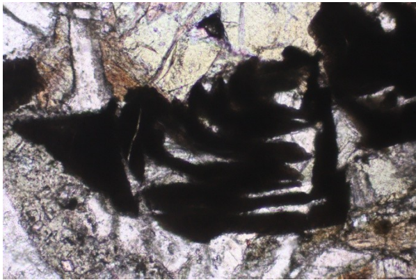
Abbildung 231: Opake bis Semi-opake Ilmenit-Skelettstruktur mit schwarz-brauner Eigenfarbe (primär magmatischer Ilmenit?), parallele Polarisatoren, PR 156, Bildbreite: 1 mm.
