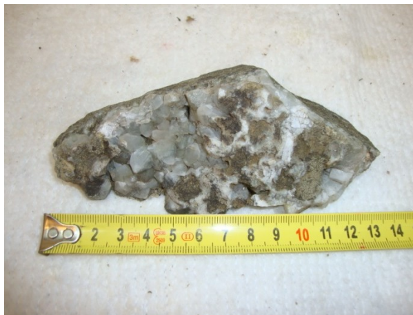
Abbildung 119: Kalzitischer Kluftbelag mit idiomorph auskristallisierten Kalzitkristallen, PR 122, siehe Kartenbeilage 1.
