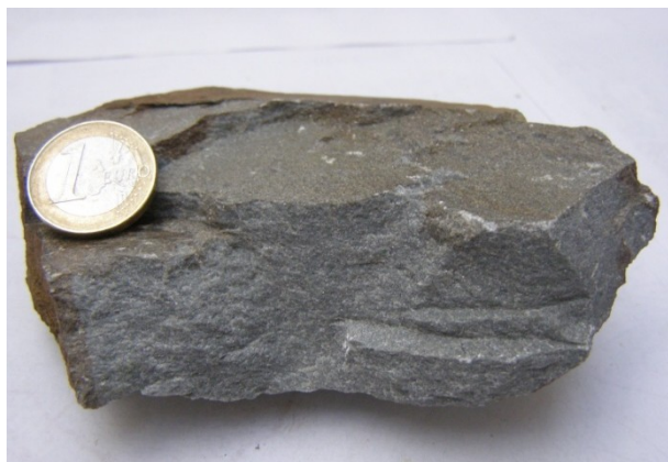
Abbildung 132: Fein- bis mittelkörniges Gesteinsgefüge der Metasandstein-Formation mit dunkelgrauer Färbung, PR 106, siehe Kartenbeilage 1.
