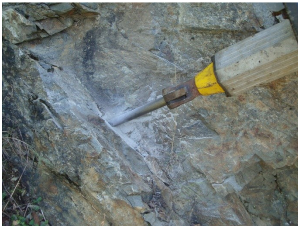
Abbildung 293: Gewinnen von wenig verwittertem/unverwittertem Probenmaterial mit einem benzinbetriebenen Schremmhammer, Aufschlusspunkt 120, siehe Kartenbeilage 1.
