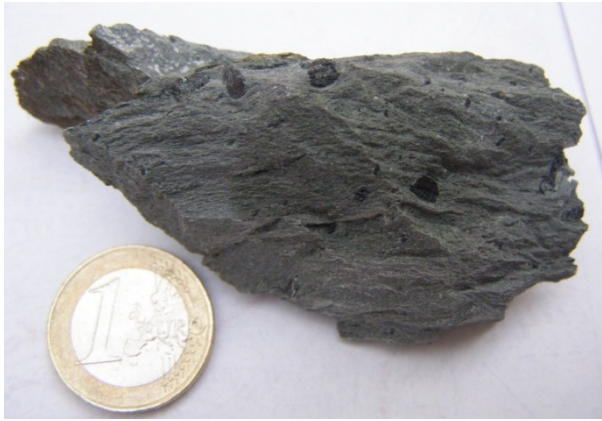
Abbildung 127: Feinkörniges, geschiefertes, graugrünes Gesteinsgefüge mit schwarzen Pyroxeneinsprenglingen, PR 404, siehe Kartenbeilage 1.
