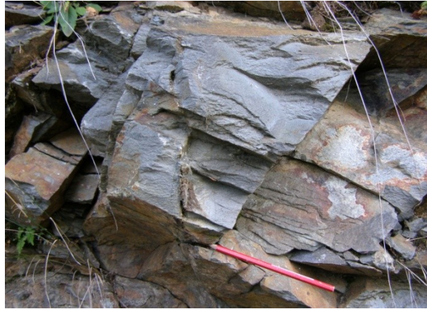
Abbildung 25: Hellgrauer, feinkörniger, stärker geklüfteter Diabas mit roten Oxidationsbelägen, Aufschlusspunkt 325, siehe Kartenbeilage 1.
