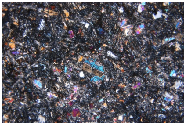
Abbildung 150: Porphyrische Einsprenglinge (leistenförmige Feldspäte und Pyroxene mit bunten Interferenzfarben, teilweise verzwilligt), gekreuzte Polarisatoren, PR 364, Bildbreite: 4 mm.
