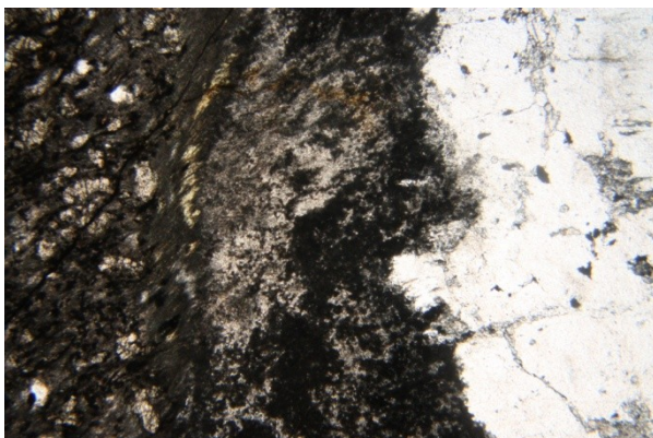
Abbildung 173: Porphyrisches Gefüge mit gedrunghenen Pyroxeneinsprenglingen (links) und einer zerscherten Extensionskluff, parallele Pol., PR 134, Bildbreite: 4 mm.
