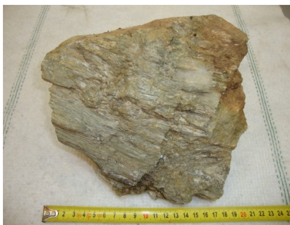
Abbildung 109: Diabashandstück mit verschiedenen Fasermineralen (Chlorit, Faserkalzit, Aktinolith) als Klüftbelag, PR 120, siehe Kartenbeilage 1.
