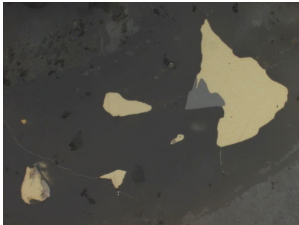
Abbildung 228: Detailaufnahme der Kupferkiesvererzung aus Abbildung 230 mit einer hellgelben Reflexion, verwachsen mit Zinkblende (dunkelgraue Reflexion), PR 156, Bildbreite: 0,177 mm.
