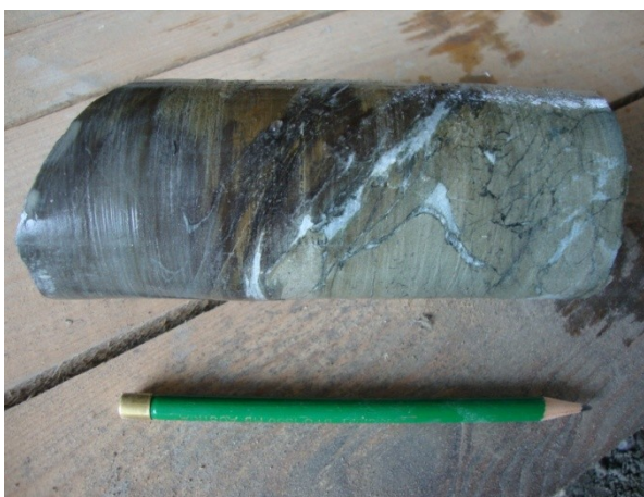
Abbildung 145: Tektonischer, kataklastisch-zerlegter Übergang zwischen Tonschiefer und Diabas (?Metatuffit), VH4/01, lfm. 77,90.
