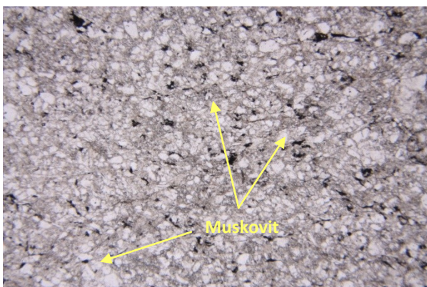
Abbildung 265: Fein- bis mittelkörniges, quarzreiches Gesteinsgefüge der Metasandsteinformation mit zahlreichen detritären Glimmern (Muskovit = leicht erhöhtes Relief), parallele Polarisatoren, PR 298, Bildbreite: 4 mm.
