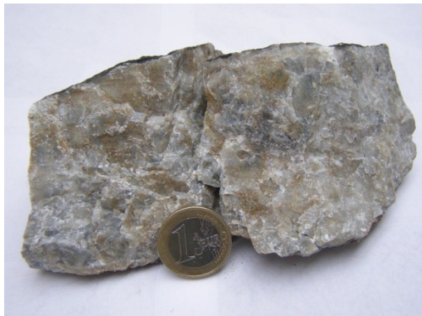
Abbildung 139: Stark rekristallisiertes, metamorph überprägtes Karbonathandstück mit weiß-braun bis blau-grauer Färbung, PR 205, siehe Kartenbeilage 1.
