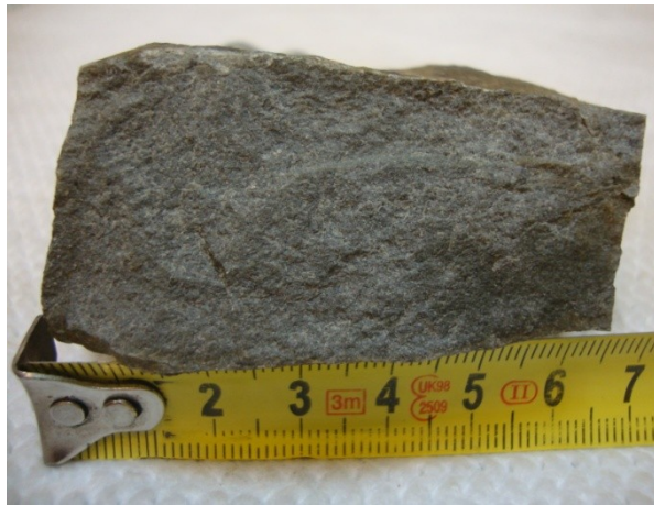
Abbildung 115: Mittel- bis grobkörniges, massig ausgebildetes Gesteinsgefüge mit dunkelgrau-grüner Färbung, PR 121, siehe Kartenbeilage 1.
