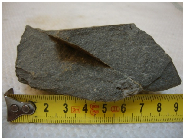
Abbildung 117: Mittelkörniges, massig ausgebildetes Gesteinsgefüge durchzogen von einer Kluffläche, PR 296, siehe Kartenbeilage 1.
