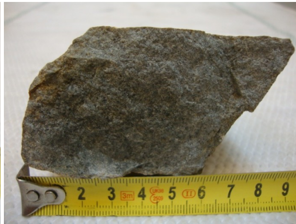
Abbildung 116: Mittel- bis grobkörniges, massig ausgebildetes Gesteinsgefüge mit dunkelgrau-grüner Färbung, PR 249, siehe Kartenbeilage 1.
