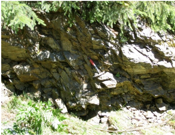
Abbildung 64: Stark geklüfteter bis stark zerlegter Metasandsteinaufschluss mit geringen Trennflächenabständen unterhalb der Jahnhütte, Aufschlusspunkt 180, siehe Kartenbeilage 1.
