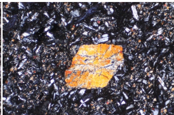
Abbildung 190: Idiomorpher Pyroxen mit Umwandlungen zu Akinolith und Chlorit entlang der Spaltflächen, gekreuzte Pol., VH6A/01, lfm. 35,15, Bildbreite: 2 mm.
