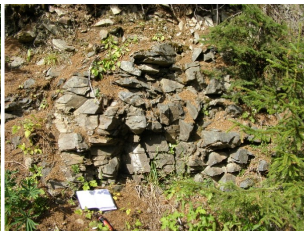
Abbildung 82: Trennflächenverschnitt zwischen Schichtungs- bzw. Schieferungsflächen (SF 017/16) und zwei Kluffscharen ( KF_1 086/69 und KF_2 226/50), Aufschlusspunkt 296, siehe Kartenbeilage 1.
