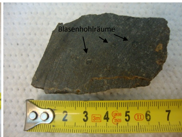
Abbildung 120: Kleine (bis maximal 5 mm Durchmesser), rundliche Blasen Hohlräume sekundär mit Kalzit und Chlorit verfüllt (rote Pfeile), PR 135, siehe Kartenbeilage 1.
