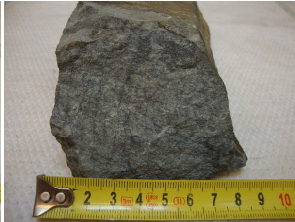
Abbildung 122: Fein- bis mittelkörniges, grau-grünes Gesteinsgefüge, durchzogen von dunklen Chloritschlieren (metamorphe Mineralneubildungen), PR 221, siehe Kartenbeilage 1.
