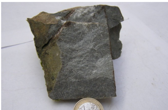
Abbildung 133: Fein- bis mittelkörniges Gesteinsgefüge der Metasandstein-Formation mit dunkelgrauer Färbung, PR 197, siehe Kartenbeilage 1.
