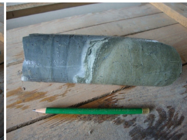
Abbildung 144: Tektonisch bewegter, kalzitischer Übergang zw. Tonschiefer und Diabas, VH5/01, lfm. 19,30.
