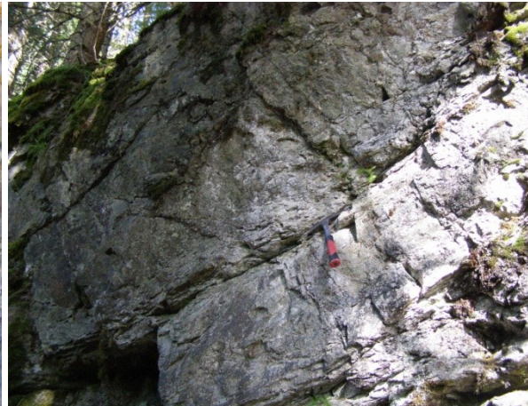
Abbildung 33: Dickbankig geschichteter Diabas mit Bewegungen entlang der Schichtflächen, Aufschlusspunkt 254, siehe Kartenbeilage 1.
