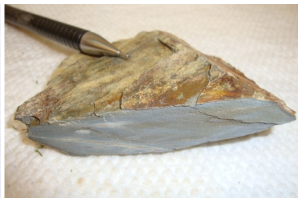
Abbildung 138: Feinkörniges Gesteinsgefüge der Tonschiefer-Formation mit rostroten Fe-Oxidationslagen und -belägen, PR 108, siehe Kartenbeilage 1.
