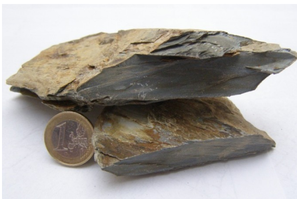
Abbildung 137: Feinkörniges dunkelgraues Gesteinsgefüge der Tonschiefer-Formation mit dunklen, Organik-reichen Zwischenlagen, PR 108, siehe Kartenbeilage 1.
