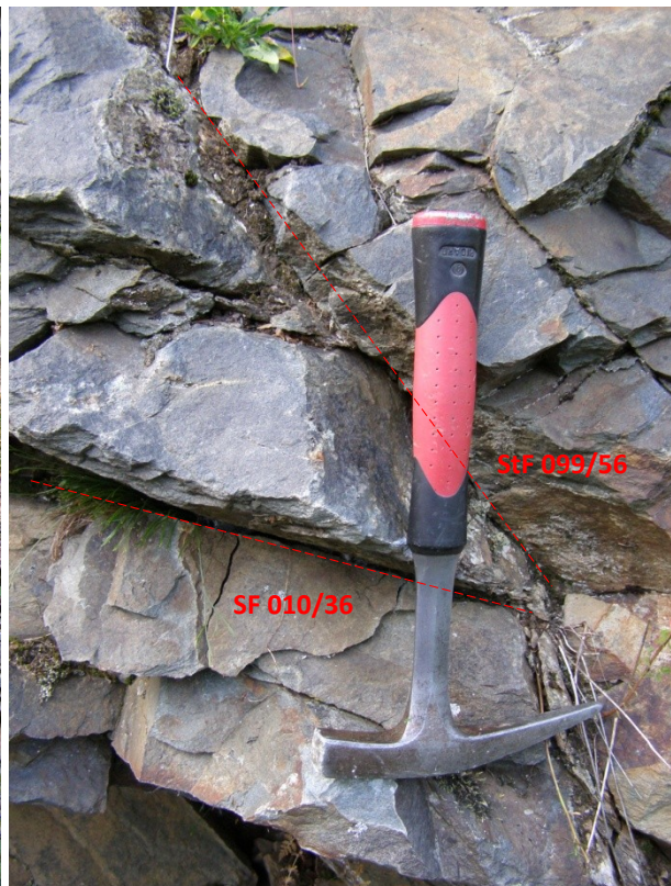
Abbildung 39: Detailaufnahme des Aufschlusspunktes 303 (siehe Kartenbeilage 1) mit geneigter, dünnbankiger Lagerung (SF 010/36) und steiler Scherung (StF 099/56).
