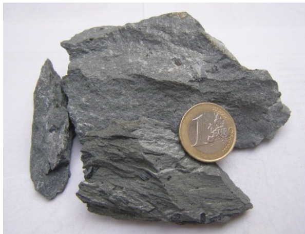
Abbildung 58: Graugrüner, fein geschieferter Metatuff mit dunklen Pyroxeneinsprenglingen, Handstück vom Aufschlusspunkt 404, Kartenbeilage 1.
