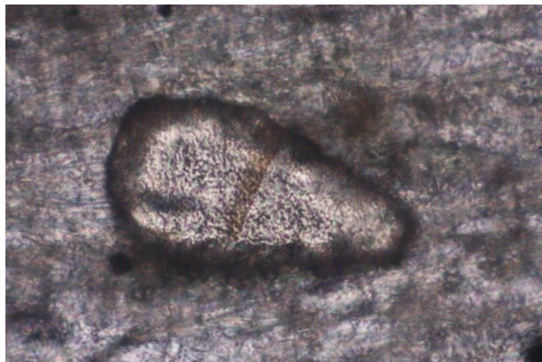
Abbildung 273: Rutilkorn mit deutlich erhöhter Lichtbrechung bzw. deutlich erhöhtem Relief, parallele Pol., PR 110, Bildbreite: 0,2 mm.
