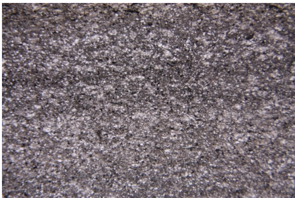
Abbildung 263: Sehr feinkörnige, quarzreiche Partie der Metasandsteinformation mit durchwegs guter Kornrundung, parallele Polarisatoren, VH1/01, lfm. 5,20, Bildbreite: 4 mm.
