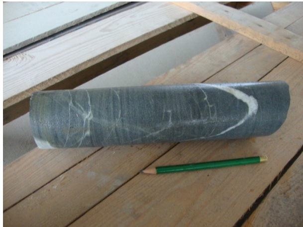
Abbildung 142: Massig ausgebildeter, grün-grauer Diabas mit steil stehender Kalzit-Kluft (KF 70), VH6A/01, lfm. 37,50.
