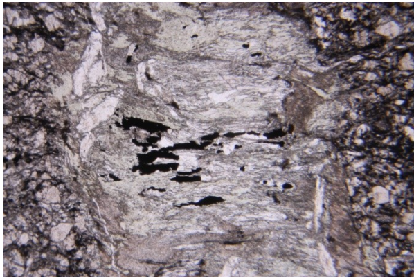
Abbildung 171: Halber Querschnitt durch einen zonar aufgebauten Ader. Ältere, nadelige Minerale werden von Quarz und in weiterer Folge Kalzit überwachsen, parallele Polarisatoren, VH5/01, lfm. 20,95, Bildbreite 4 mm.
