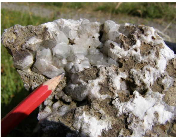
Abbildung 42: Detailaufnahme einer Hohlraum-Klufffüllung (Handstückaufnahme) mit idiomorph auskristallisierten Kalzitkristallen, Aufschlusspunkt 122, siehe Kartenbeilage 1.
