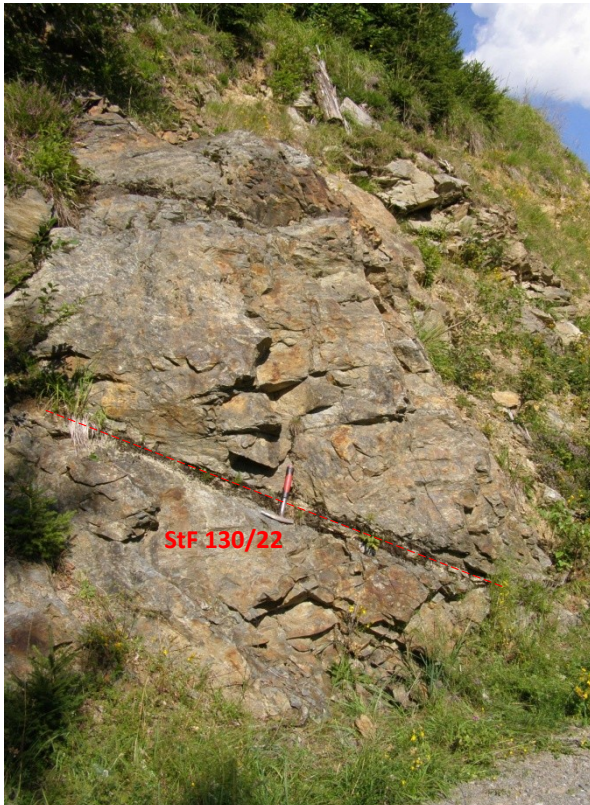
Abbildung 36: Massiger Diabasaufschluss mit kakiritisch ausgebildeter Störungsfläche, StF 130/22, Aufschlusspunkt 120, siehe Kartenbeilage 1.
