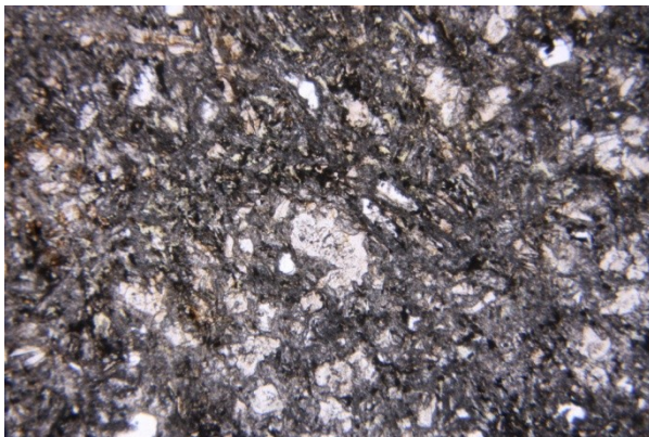
Abbildung 149: Mittel- bis grobkörniges Gefüge mit porphyrischen Einsprenglingen (Feldspäte und Pyroxene, teilweise verzwilligt) in einer feinkörnigen Matrix, parallele Polarisatoren, PR 364, Bildbreite: 4 mm.
