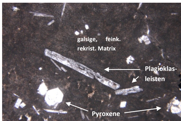
Abbildung 199: Feinstkörnig-rekristallisierte, glasige Matrix mit wenigen porphyrischen Plagioklas- und Pyroxeneinsprenglingen, parallele Polarisatoren, PR 348, Bildbreite: 4 mm.
