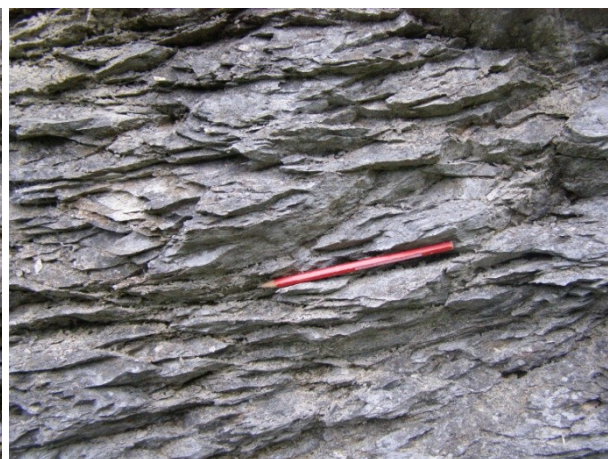
Abbildung 31: Tektonisch stark beanspruchter Diabas mit einem fein geschiefertem Gesteinsgefüge, Aufschlusspunkt 444, siehe Kartenbeilage 1.
