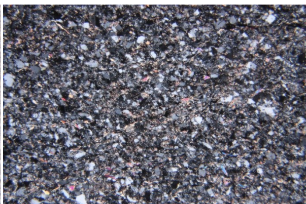
Abbildung 266: Fein- bis mittelkörniges, quarzreiches Gesteinsgefüge der Metasandsteinformation mit zahlreichen detritären Glimmern (Muskovit = bunte Interferenzfarben), gekreuzte Polarisatoren, PR 298, Bildbreite: 4 mm.
