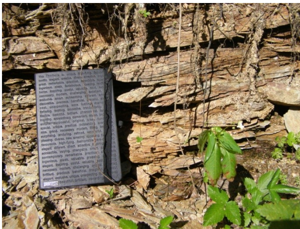
Abbildung 66: Feingeschieferter bis phyllitischer, grauer Tonschiefer mit braun-roten Fe-Oxidationen entlang der Trennflächen, Aufschlusspunkt 228, siehe Kartenbeilage 1.
