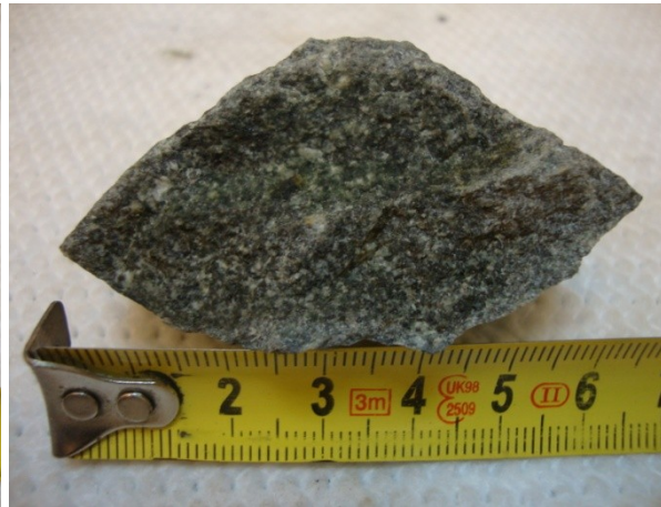
Abbildung 126: Grobkörniges Gefüge mit hellen, leistenförmigen Feldspat und dunklen, gedrungenen Pyroxeneinsprenglingen, PR 233, siehe Kartenbeilage 1.
