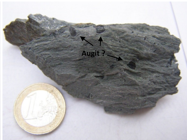
Abbildung 59: Detailaufnahme des Metatuffhandstücks vom Aufschlusspunkt 404 mit größeren, schwarzen Pyroxeneinsprenglingen (Augit?).
