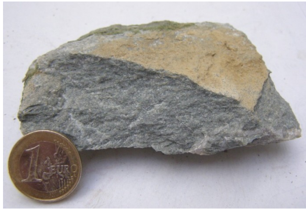
Abbildung 130: Mittelkörniges Gesteinsgefüge der Metasandstein-Formation mit hellgrauer Färbung, PR 112, siehe Kartenbeilage 1.
