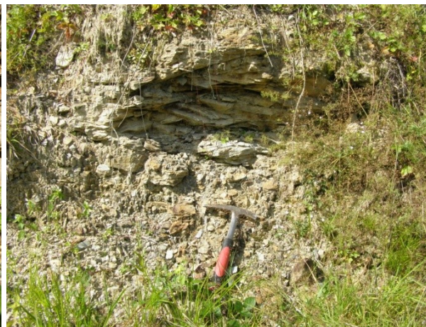
Abbildung 67: Söhlig gelagerter bzw. flach in Richtung Nord-Nordwest einfallender, grauer Tonschiefer, Aufschlusspunkt 284, siehe Kartenbeilage 1.
