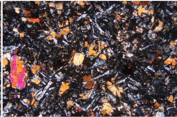
Abbildung 184: Gut verschränkte, längs gestreckte, verzwilligte Feldspatleisten (grau-weiß) und porphyrische, teilweise verzwilligte Pyroxene (rosa-orange Interferenz), gekreuzte Polarisatoren, PR 105, Bildbreite: 4 mm.
