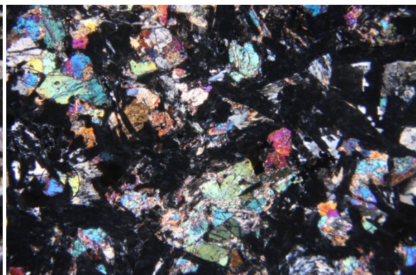
Abbildung 220: Stark umgewandelte Feldspatleisten und gedrungene Pyroxeneinsprenglinge mit bunten Interferenzfarben, gekreuzte Pol., PR 338, Bildbreite: 4 mm.
