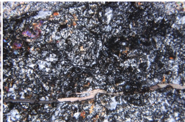
Abbildung 256: Reliktische Überreste von porphyrischen Pyroxeneinsprenglingen mit bunten Interferenzfarben im linken oberen Bildbereich und einem Karbonatgang im unteren Bildbereich, gekreuzte Polarisatoren, VH4/01, Ifm. 83,70, Bildbreite: 4 mm.
