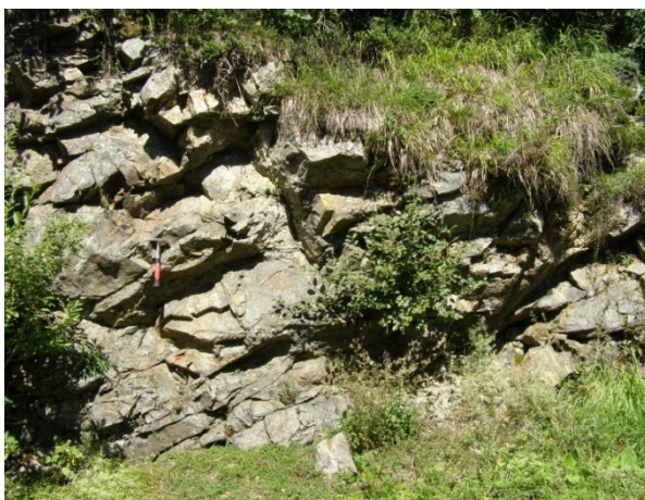
Abbildung 81: Trennflächenverschnitt zwischen Schichtungs- bzw. Schieferungsflächen (SF 314/26) und zwei Kluffscharen ( KF_1 060/80 und KF_2 176/50), Aufschlusspunkt 177, siehe Kartenbeilage 1.
