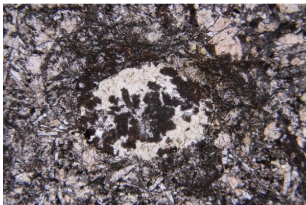
Abbildung 191: Leukoxenreiche Hohlraumfüllung einer Gasblase, parallele Pol., PR 105, Bildbreite: 4 mm.
