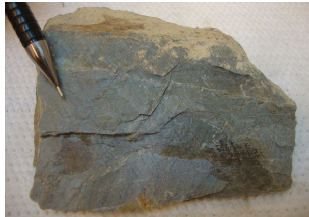
Abbildung 136: Schieferungsflächen mit serizitischem Glanz und Knickfältelung, Blick auf die Schieferungsfläche, PR 102, siehe Kartenbeilage 1.
