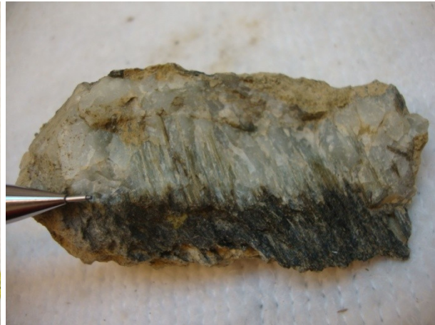
Abbildung 112: Detailansicht einer Fasermineralkluftfüllung mit Quarz (heller Bereich) und Chlorit und/oder Aktinolith (dunkler Bereich), PR 312, siehe Kartenbeilage 1.
