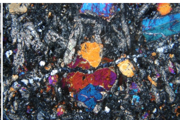
Abbildung 156: Porphyrische Pyroxenminerale (bunte Interferenzfarben, häufig verzwillingt), gekreuzte Polarisatoren, PR 120, Bildbreite: 4 mm.
