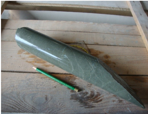
Abbildung 141: Massig ausgebildeter, grüner Diabas mit feinen Quarz- und Kalzitadern, VH4/01, lfm. 84,00.
