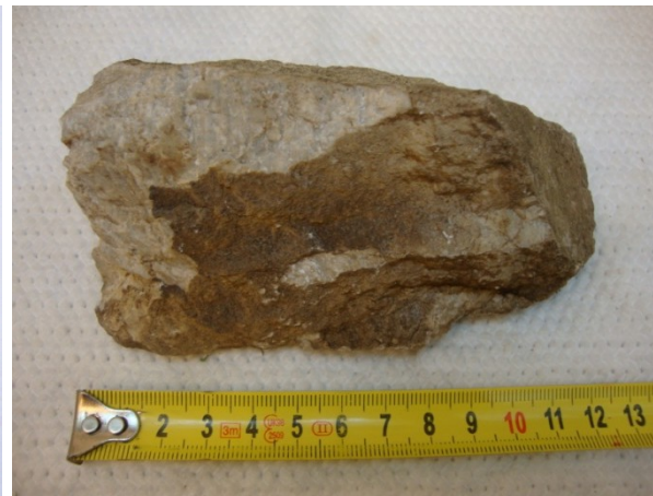
Abbildung 140: Karbonatgesteinshandstück mit grusig verwitterter Oberfläche und Fe-Oxidationsbelägen, PR 205, siehe Kartenbeilage 1.
