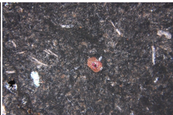
Abbildung 206: Feine, langgestreckte Feldspatleisten und teilweise idiomorphe Pyroxene mit bunten Interferenzfarben, gekreuzte Polarisatoren, PR 348, Bildbreite: 4 mm.
