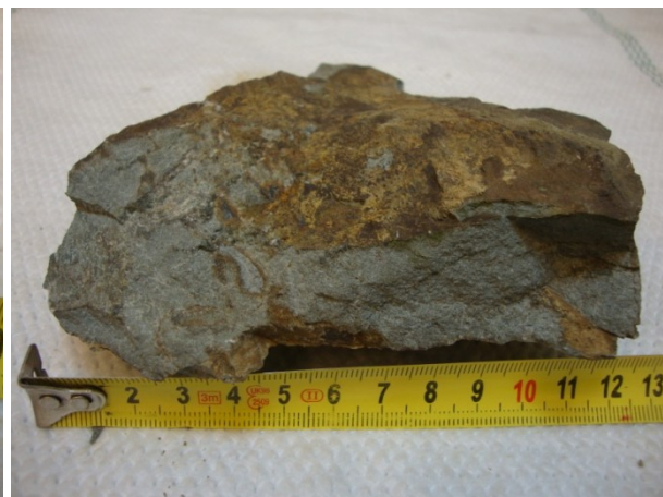
Abbildung 106: Fein- bis mittelkörniges Gefüge mit rostroten Oxidationsbelägen an den Klufflächen, PR 225, siehe Kartenbeilage 1.
