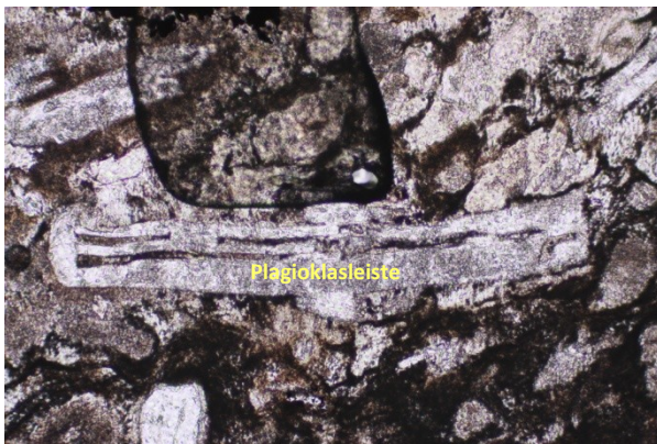
Abbildung 203: Stark umgewandelte/zersetzte, idiomorphe Feldspatleiste mit polysynthetischer Verzwilligung (Lamellierung), parallele Polarisatoren, PR 348, Bildbreite: 1 mm.
