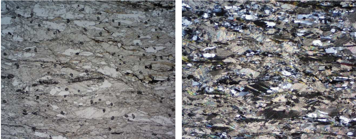
Abbildung 26: Dünnschliffaufnahme des Bündnerschiefers (Universität Innsbruck)
