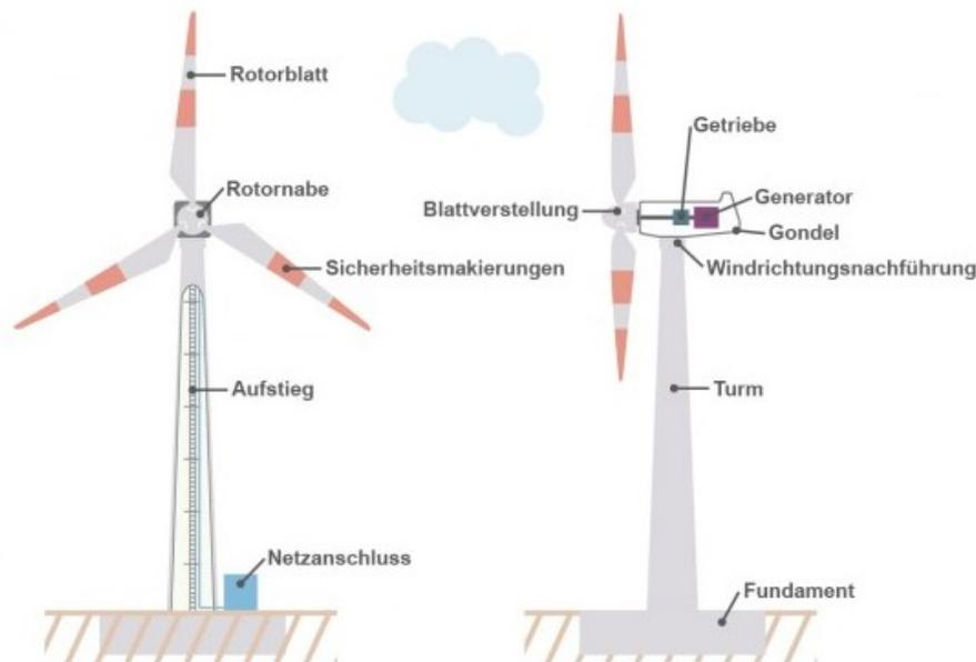
Abbildung 22: Aufbau einer Horizontalachsen-Windkraftanlage mit Getriebe<sup>83</sup>
