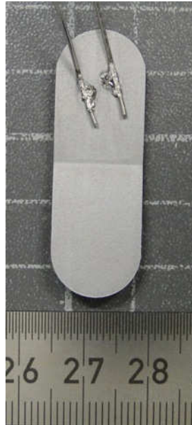
Abb. 5-2: Vorbehandelte Probe mit angeschweißtem Ni/CrNi-Thermoelement
