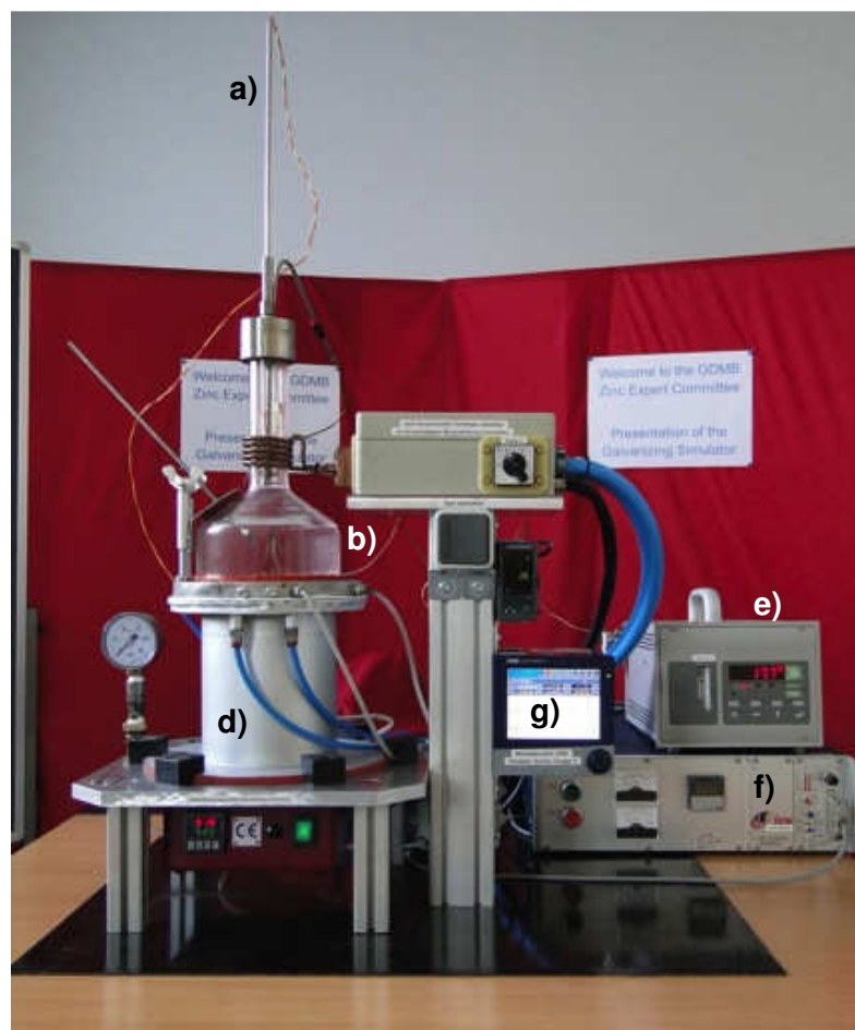
Abb. 5-1: Schmelztauchsimulator der Wuppermann Austria GmbH: a) Fahrstange b) Quarzglocke c) Schmelzkessel d) Prozessregler e) Oxygen Analyser f) Induktionswärmeanlage g) Bildschirmschreiber
