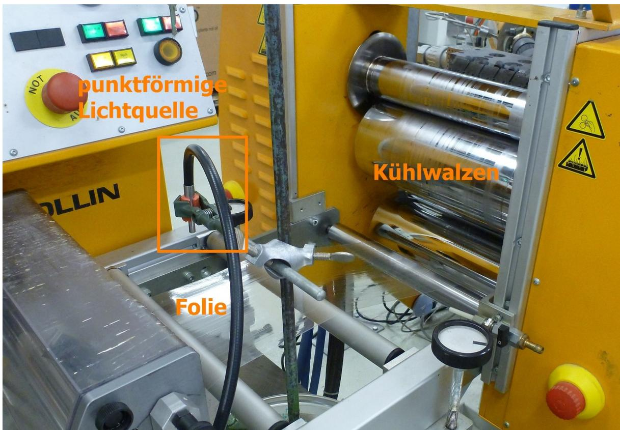
Abbildung 30: Standort der UV-Lichtquelle nach der Kühlwalze
