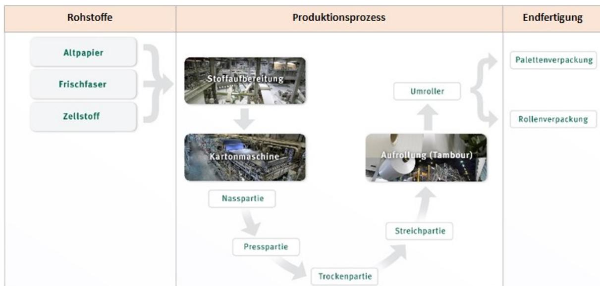
Abbildung 4: Prozessstufen
