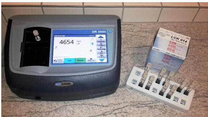
Abbildung 13: Photometer DR 3900 mit aufgeschlossenen Küvetten
