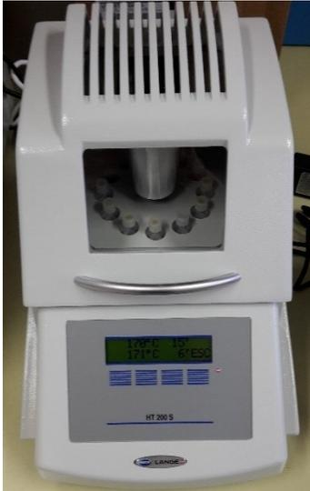
Abbildung 12: Hach Lange Thermostat HT 200 S während des Aufschlussprogrammes mit eingesetzten Küvetten
