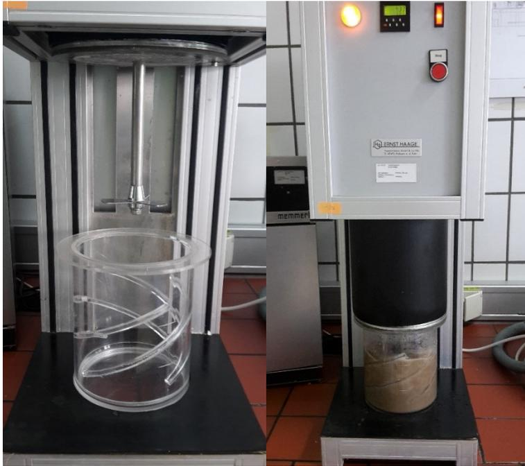
Abbildung 16: Aufschlaggerät im leeren und befüllten Zustand
