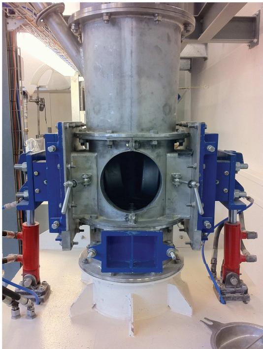
Abbildung 5-2: Blick in den Mahlraum der Vertikalmühle VRM2 der Firma Cemtec im Aufbereitungstechnikum des Lehrstuhls für Aufbereitung und Veredlung
