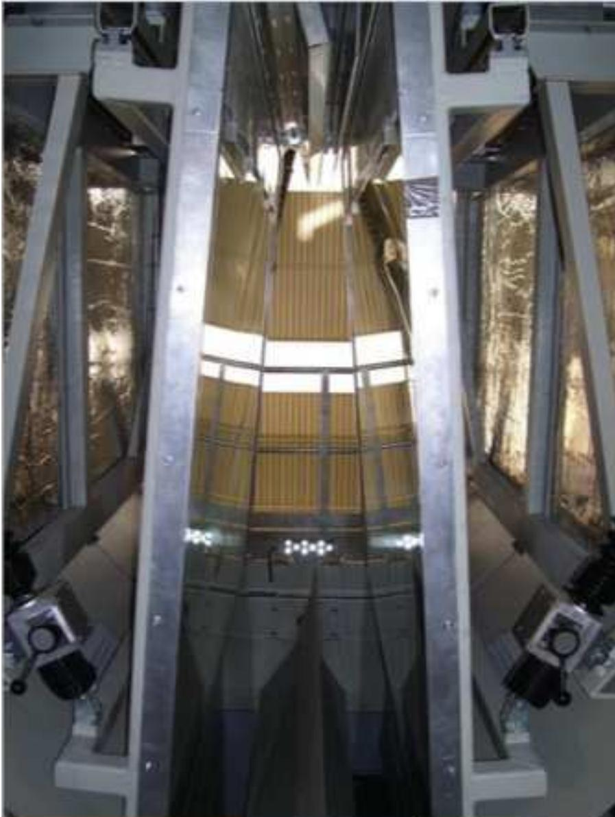
Abbildung 4-14: Blick in den Trennraum des hamos EMS 500 [8]
