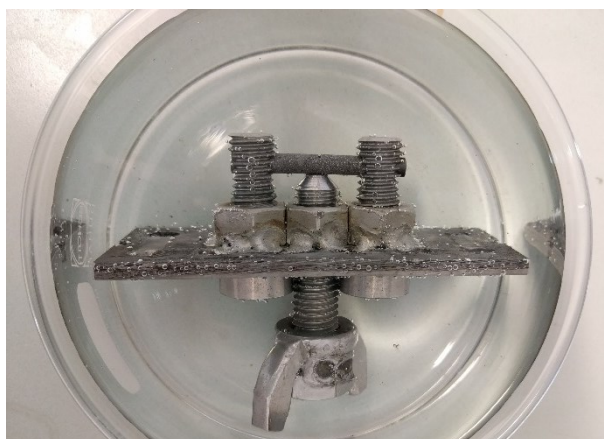
Abbildung 3-6: Biegevorrichtung für Auslagerungsversuche in Salzsäure zur Beurteilung der Empfindlichkeit auf SprK
