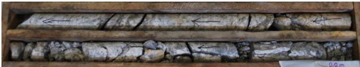
**Abbildung 22: Bohrkern aus der Strecke H**
