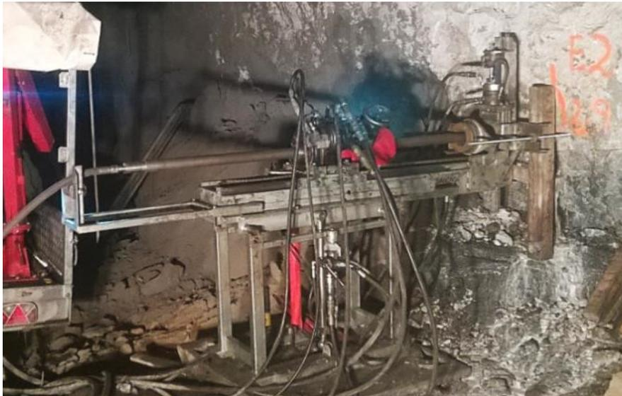
**Abbildung 21: Kernbohrgerät Sandvik DE110**
