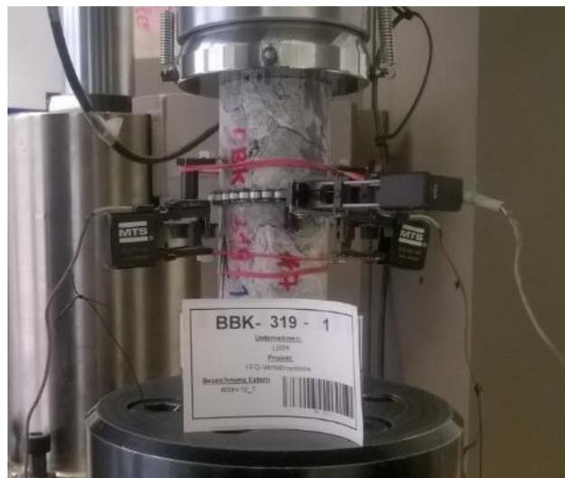
**Abbildung 24: In der hydraulischen Prüfpresse eingespannte Probe**
