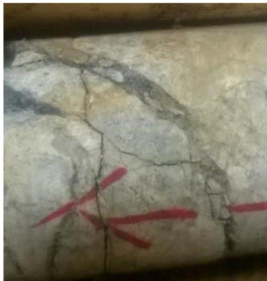
**Abbildung 3: Gefüllte Diskontinuität in einem Bohrkern**
