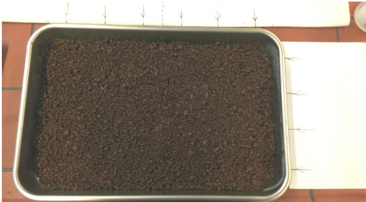
Abbildung 28: Materialvorbereitung für den Sinterkerzenversuch V8; die Pfeile an den Rändern des Blechs markieren die Positionen, an denen Harnstofflösung aufgesprüht wurde.
