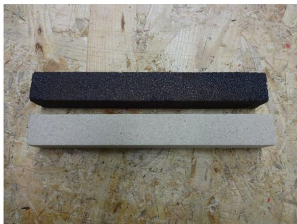
Abb. 4-4: (a) H32 Coldbox Proben bei 400°C und reduzierenden Bedingungen sowie Kondensatablagerungen, (b) Gegenüberstellung behandelte zu unbehandelte Probe.
