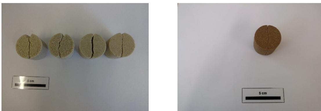
Abb. 4-11: (l) Spaltzugfestigkeit mit Lastverteilungstreifen und (r) ohne Lastverteilungstreifen für verschiedene Coldbox Proben vor und nach der thermischen Auslagerung .
