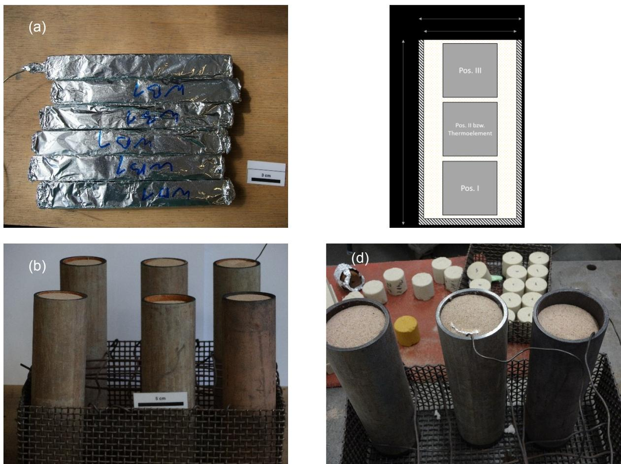
Abb. 3-13: (a) ummantelte Biegeriegel, (b) vorbereitete Biegeriegel in Versuchsvorrichtung, (c) Positionierung der Zylinderproben in Versuchsvorrichtung, (d) ummantelte Zylinderproben in Versuchsvorrichtung.
