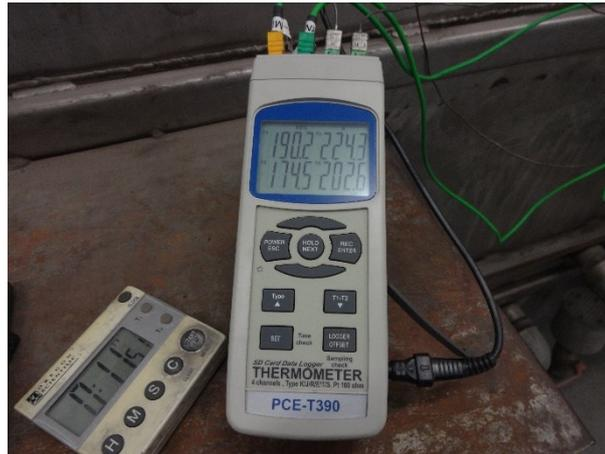
Abb. 3-7: Digitales Mehrkanaliges - Temperaturmessgerät PCE-T 390, für K-Typ, J-Typ und Pt100 Temperaturfühler.
