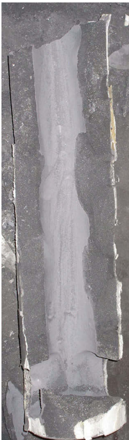
Abbildung 5-1.: Probe von einem Tauchausguss. Zu sehen sind Schlackenzone und Grundkörper.
