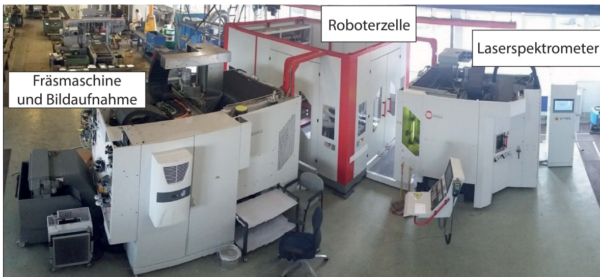
Abbildung 3-18.: Übersicht über das SILENOS-Prüfsystem, bestehend aus einer Fräsmaschine, Roboterzelle und LIBS-Maschine vgl. [9].
