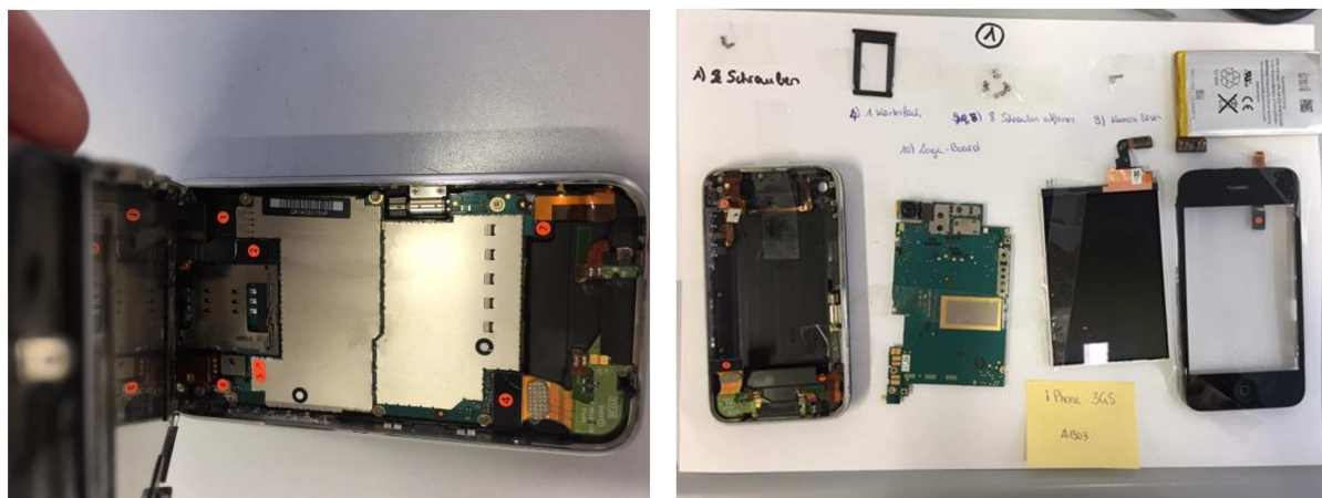
Abbildung 25: Inneres des iPhone 3 GS mit Kennzeichnung (links) und Einzelteile (rechts)
