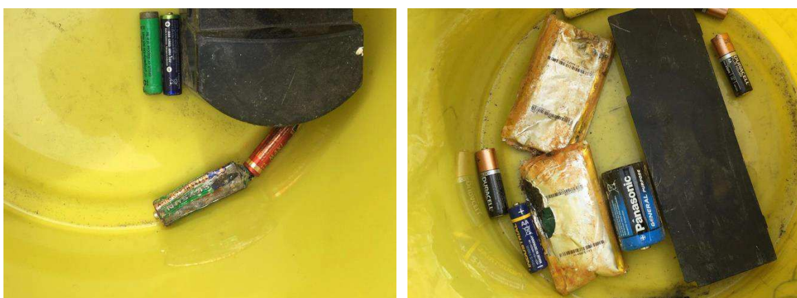
Abbildung 17: Zustand der Batterien starke Deformation (links) und zerstörte Pouchzellen (rechts)
