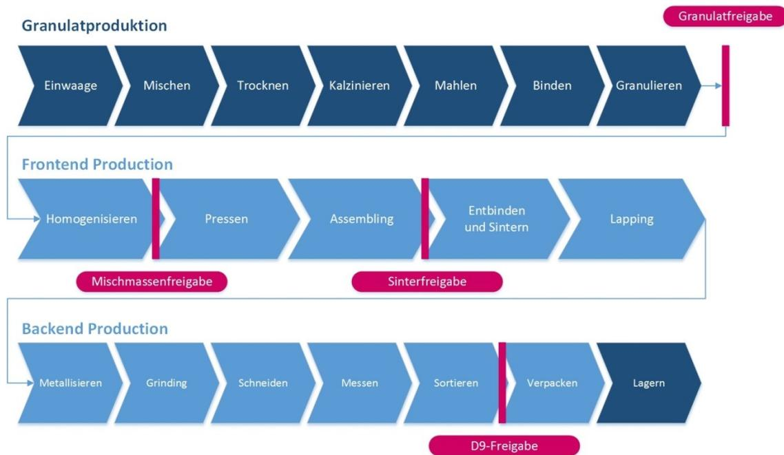
**Abbildung 1: Produktionsprozess der PTC-Bauteile<sup>3</sup>**
