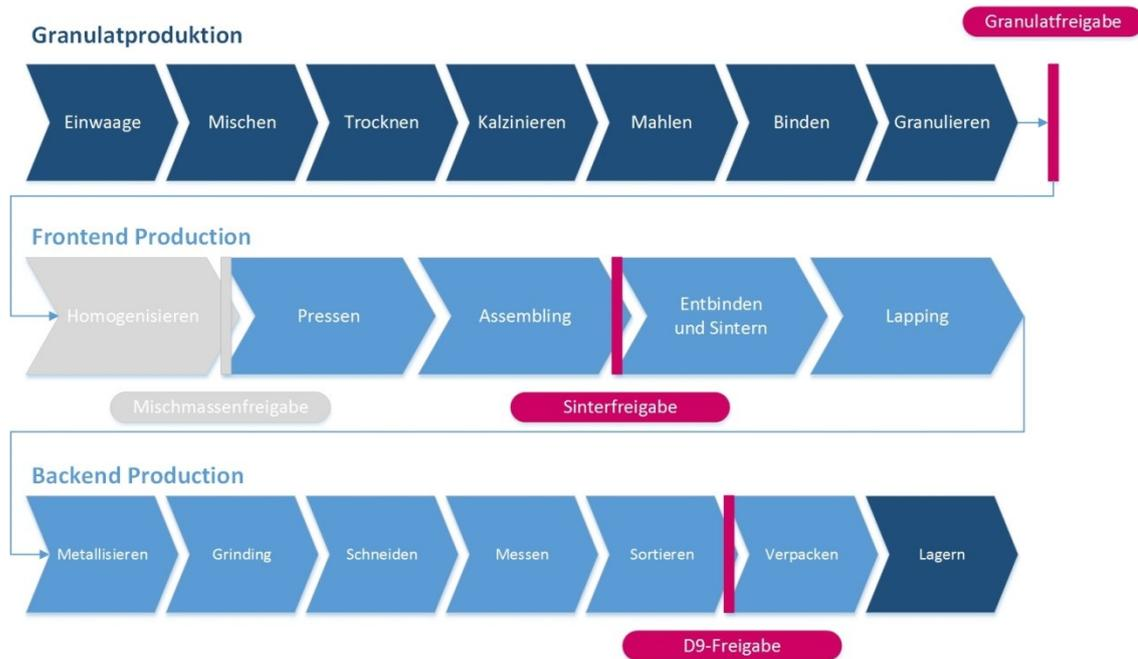
Abbildung 29: Produktionsprozess der PTC-Bauteile<sup>259</sup>
