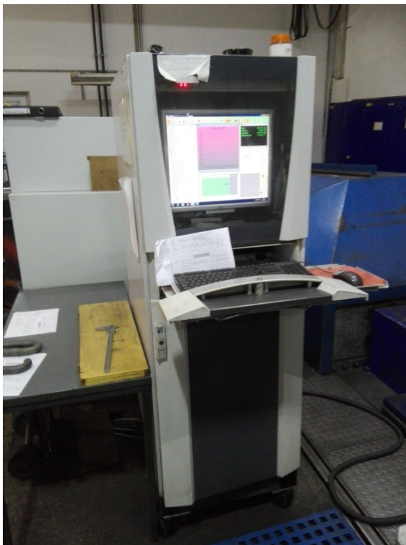
Abbildung 77: Computer der Kettenzugprüfmaschine zur Datenerfassung
