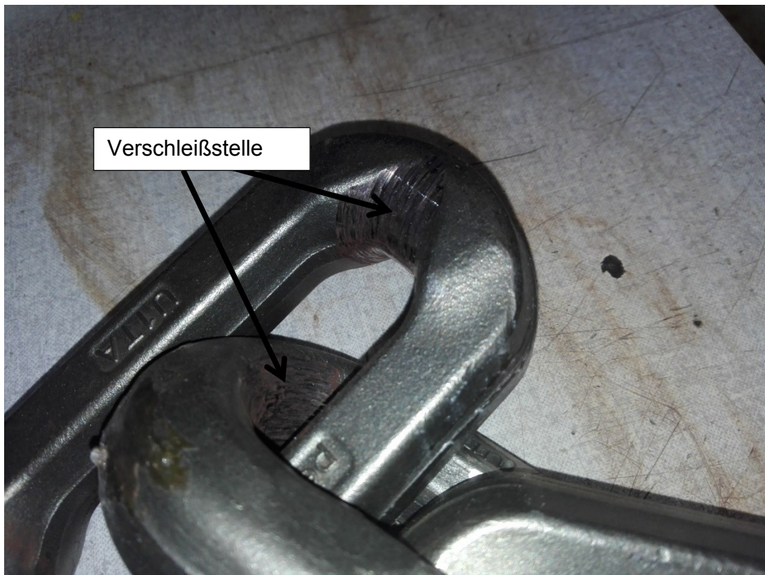
Abbildung 90: Fertige Verschleißprüfung der alten Geometrie
