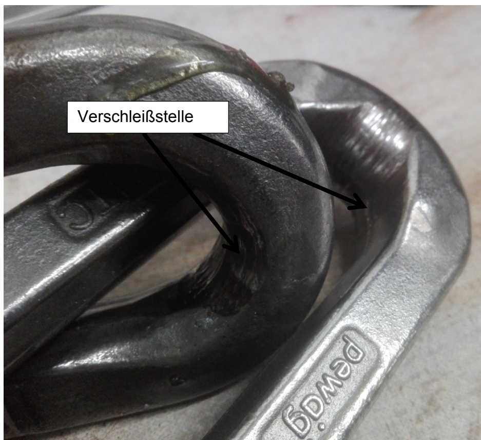
Abbildung 93: geprüfte U1TE-U1TC-Geometrie, Hubgeschwindigkeit 14%
