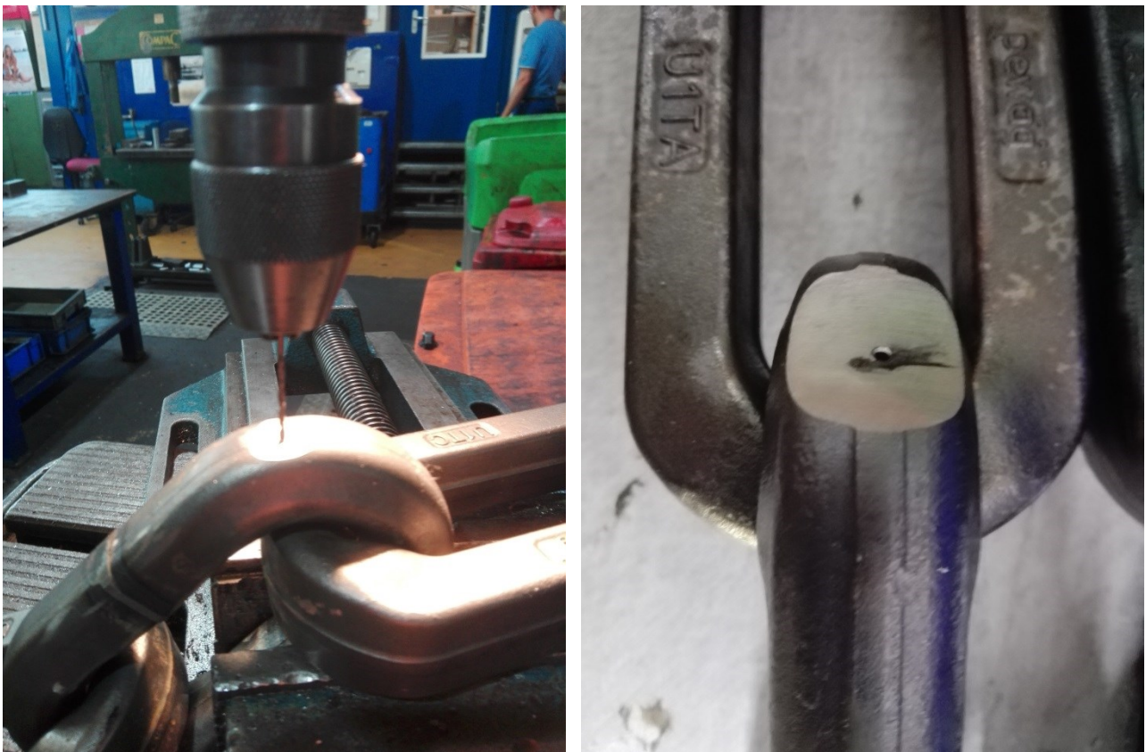
Abbildung 65: Bohrung für Temperaturmessfühler
