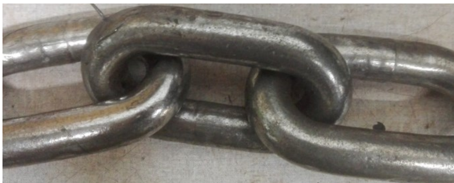
Abbildung 86: Rundstahlkette aus 18CrNiMo7-6
