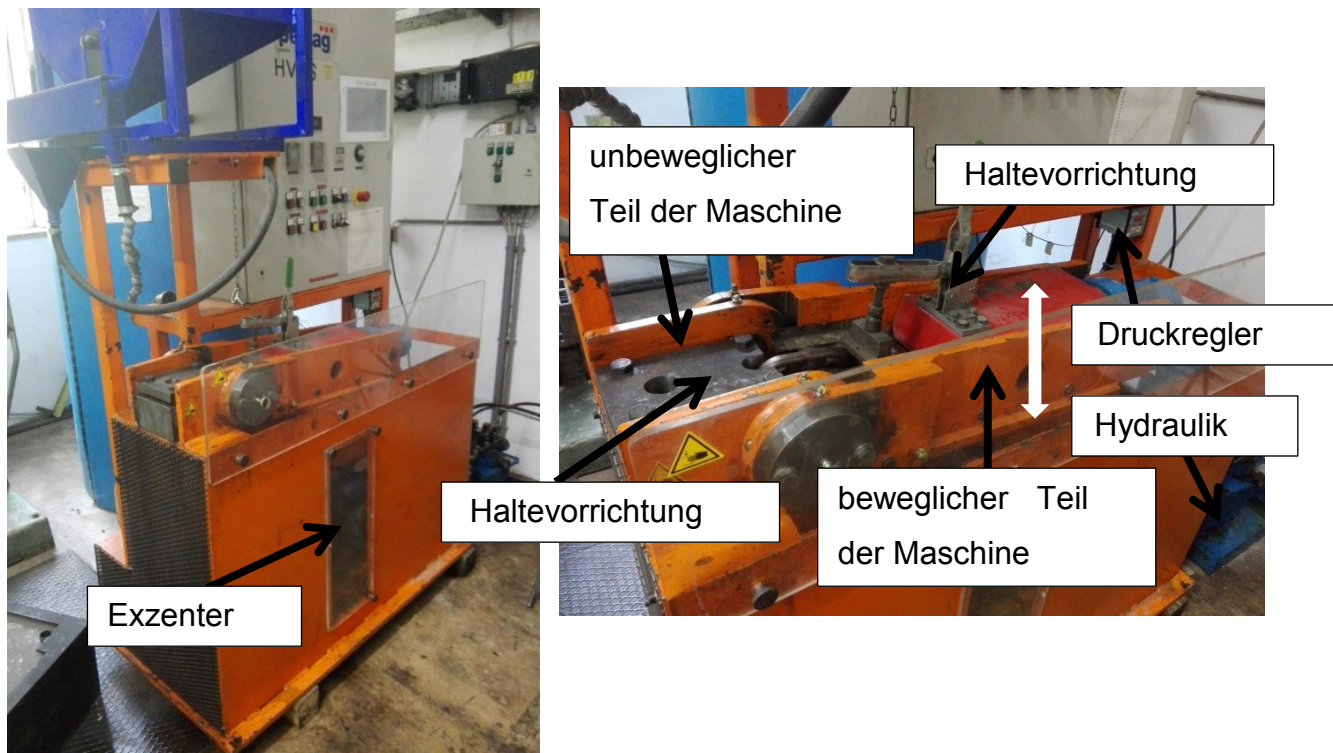
Abbildung 59: Schwenktribometer der Fa. Pewag
