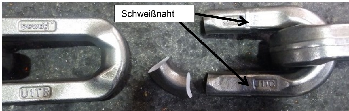
Abbildung 104: Bruchbild nach einem Kettenzugversuch
