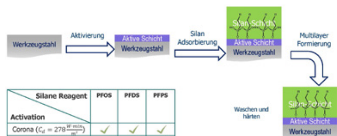
Aufbringung von verschiedenen Perfluoralkylsilanen (PFOS, PFDS, PFPS) [1]
