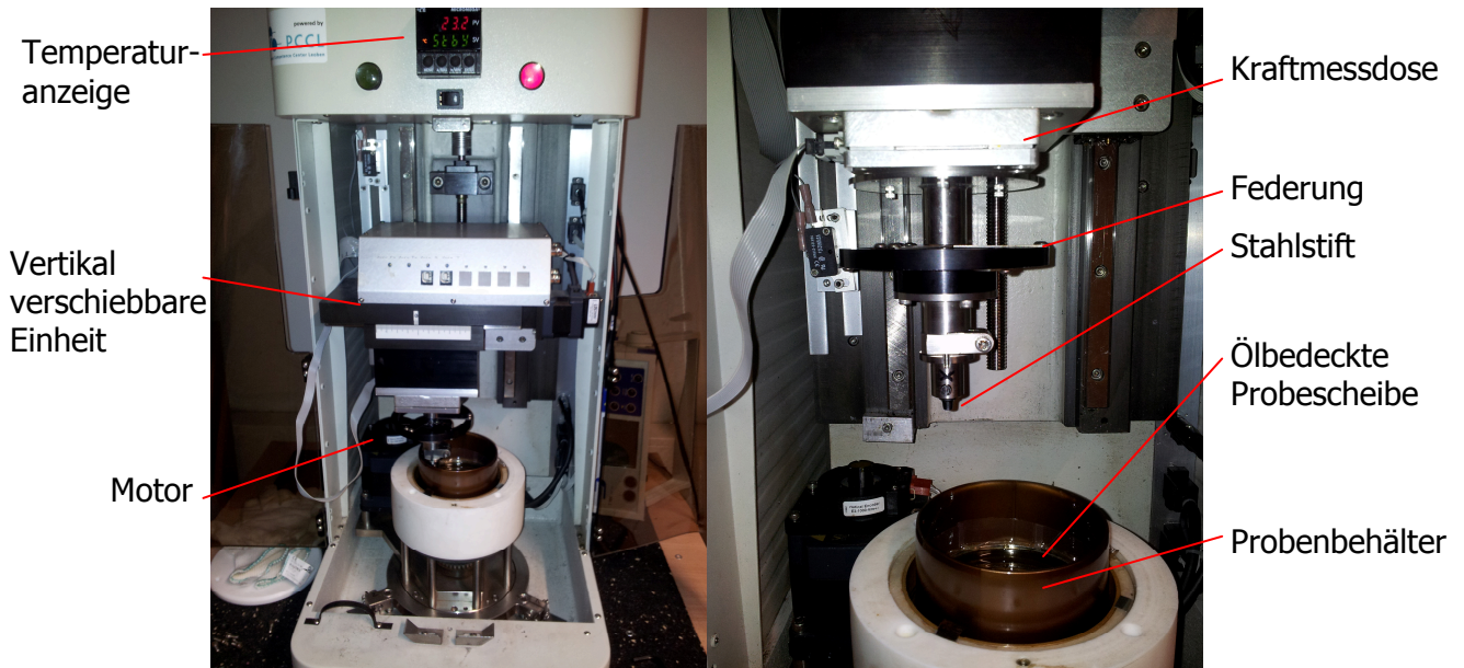
Abbildung 15: Das Tribometer CETR-UMT-2 während (li.) und nach (re.) einer Messung.
