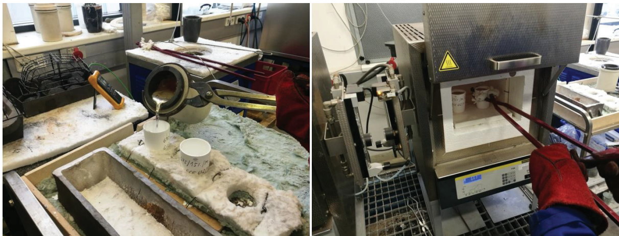
Abbildung 13: Übergießen der Probe mit Zn (links) und Einbringen der Tiegel in den Halteofen (rechts)
