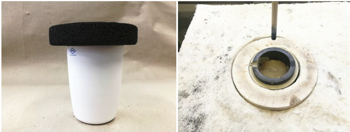
Abbildung 12: Tiegel mit Graphitabdeckung (links) und Zinkschmelze unter Argonspülung (rechts)
