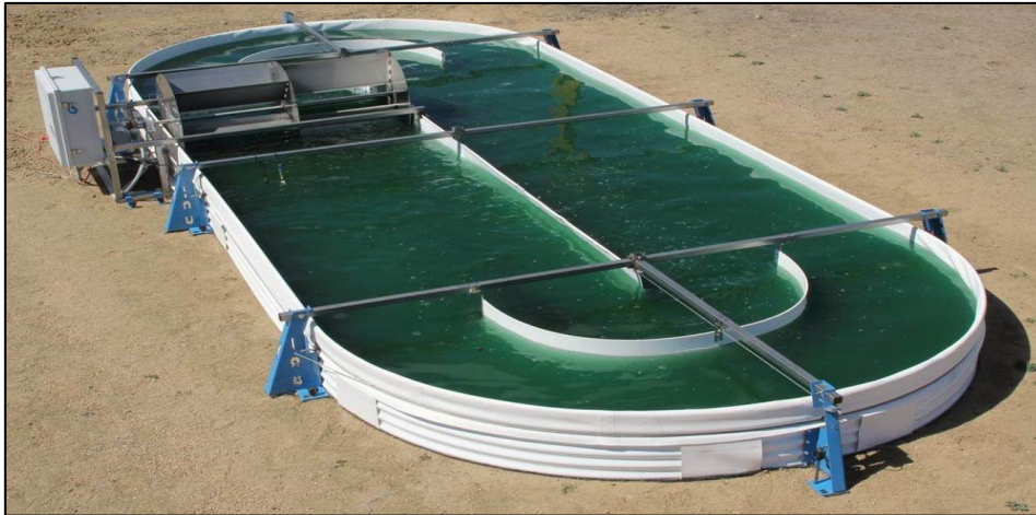
Abbildung 4-10: „Raceway ponds“ mit Schaufelräder zur Durchmischung [61]
