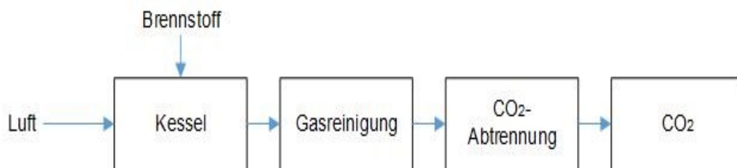
Abbildung 3-8: Vereinfachtes Schema des Post-Combustion-Verfahrens zur CO 2 -Abscheidung
