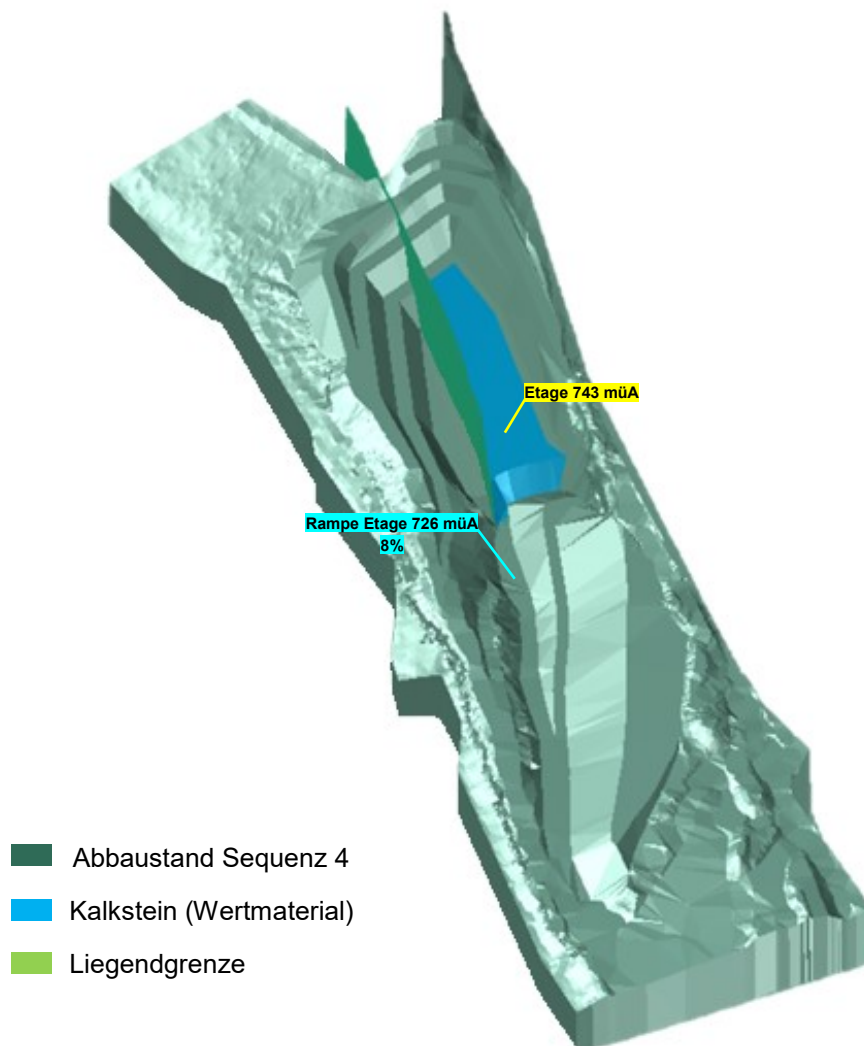
Abbildung 45: Abbau- und Auffüllung Sequenz 4, Variante 2
