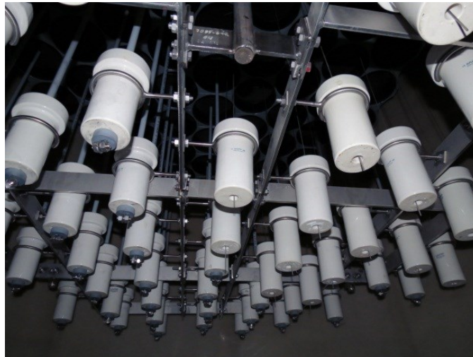
Abbildung 27: Niederschlagselektrodenbündel mit Sprühelektroden 133
