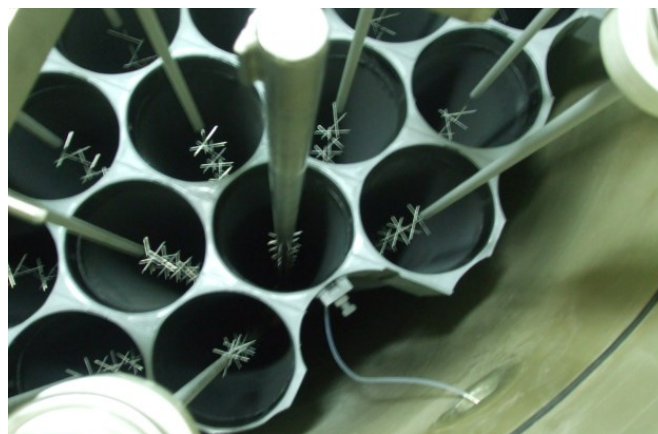
Abbildung 27: Niederschlagselektrodenbündel mit Sprühelektroden 133
