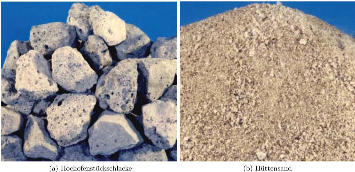
Abbildung 2.4: Hauptprodukte der Aufbereitung von Hochofenschlacke [30]
