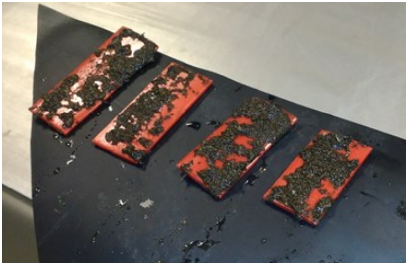
Abbildung 31: PE-LD Proben mit Anhaftungen.
