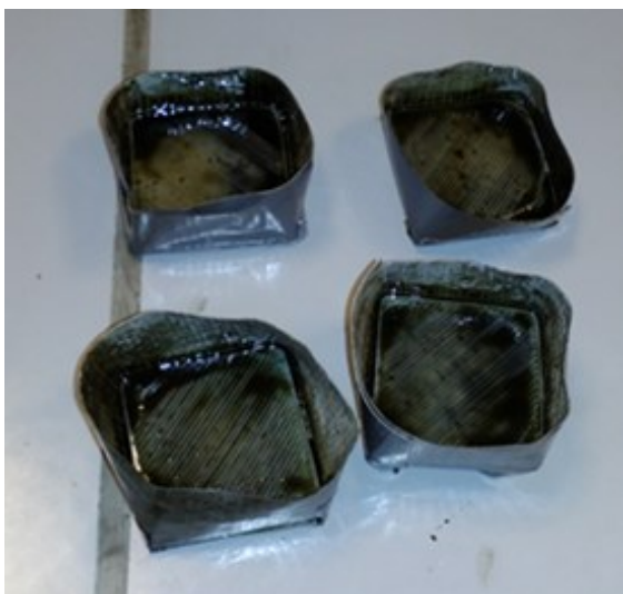
Abbildung 27: PS-HI Teile mit Altöl benetzt.
