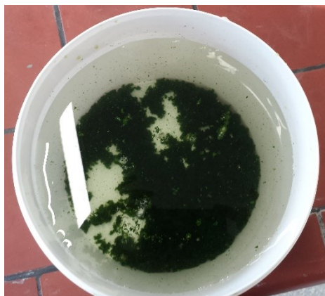
Abbildung 22 – Algensuspension nach Zugabe des Flockungsmittels
