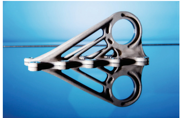
(b) Verbindungselement ( bracket ) im Airbus A350 aus lasergeschmolzenem Ti6Al4V [9, 12]
