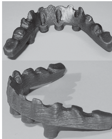
(d) Dentalimplantat aus einer CoCr-Legierung [6]
