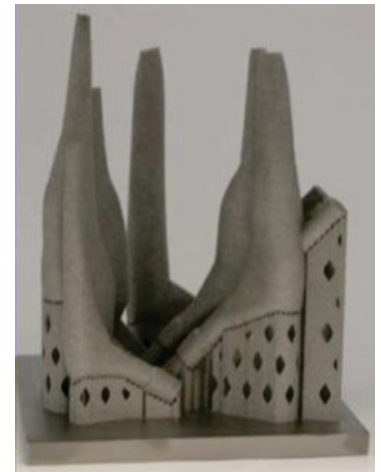
(e) Elektronenstrahlgeschmolzene Hüftprothese aus Ti6Al4V [5]
