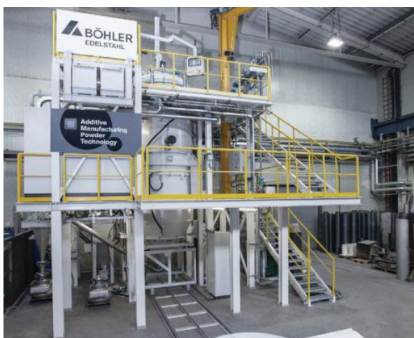
(a) VIGA - Verdüsungsanlage
