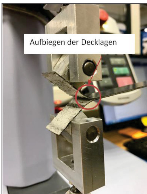
Abbildung 36: Aufbiegeverhalten der Sandwichlagen während eines Schälversuches.
