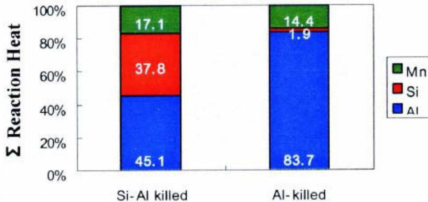
**Abbildung 3-22:** Vergleich der oxidierten Elemente zwischen Si-Al und Al beruhigten Stählen durch das chemische Heizen [23]
