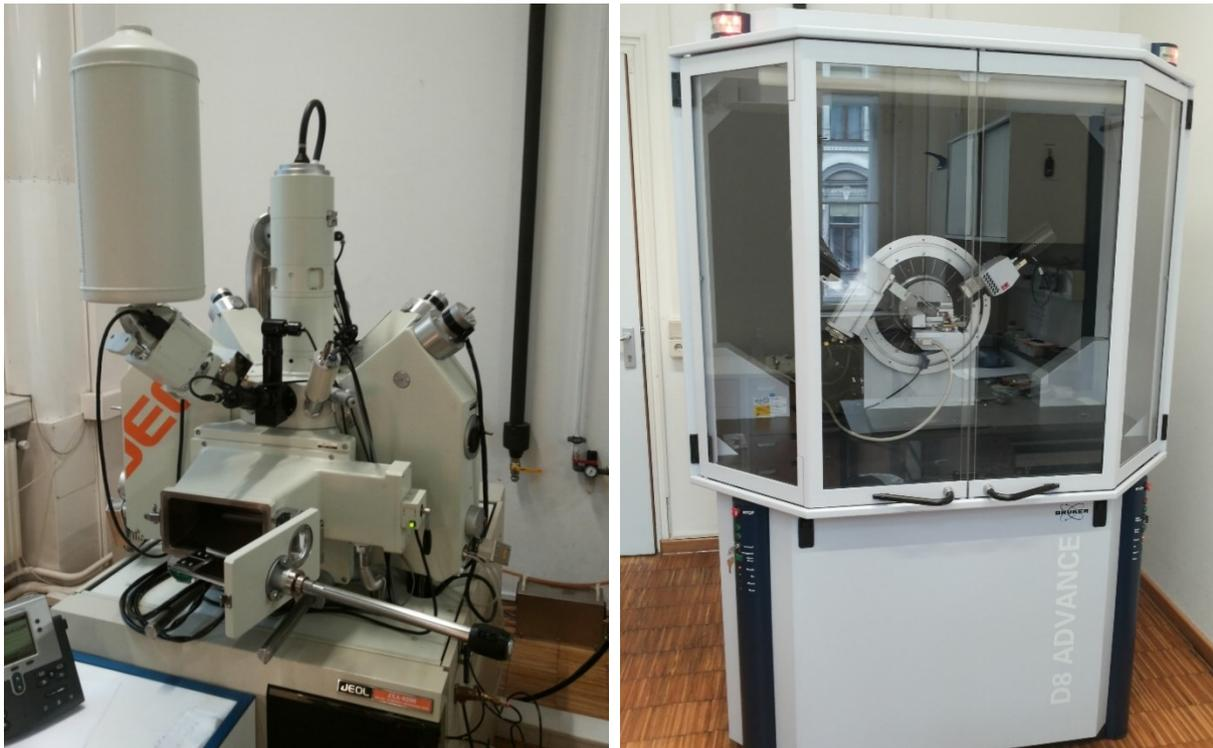
Abbildung 14: links: Elektronenstrahlmikroskop am Lehrstuhl für Rohstoffmineralogie, rechts: Röntgendiffraktometer am Lehrstuhl für Gesteinshüttenwesen
