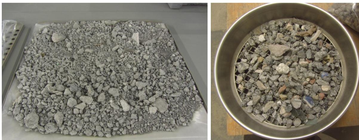
Abbildung 36: links: gesamte Probe CR28 im Einheitsgrau nach der Trocknung. rechts: Siebrückstand bei 8 mm, mit erkennbaren Ziegel- und Keramikbruchstücken
