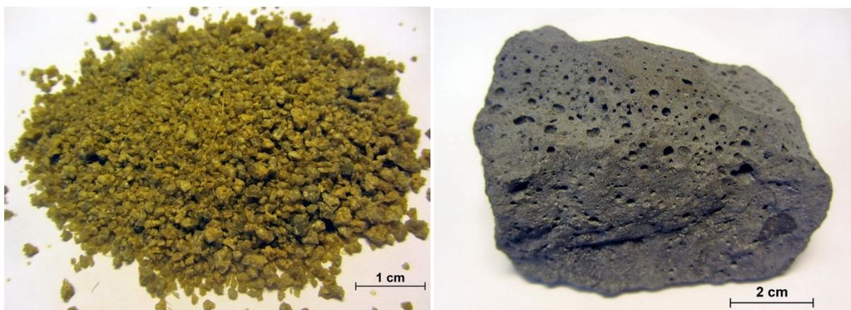
Abbildung 10: links: granulierte Hochofenschlacke (Hüttensand); rechts: LD-Schlacke
