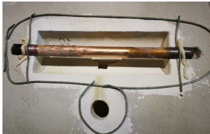
Abbildung 3.12: Probenformhälfte fertig vorbereitet direkt vor dem Zusammensetzen des Unter- und Oberkastens - Silikatsand mit Amasilic Binder von Foseco und SEMCO Schichte.
