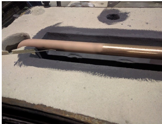
Abbildung 3.20: Vorbereitete Oberform mit eingelegtem Rohr, die linke Hälfte des Rohrs ist sandgestrahlt, die rechte geschliffen mit K60.
