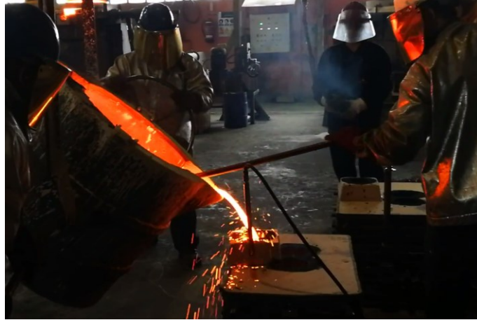
Abbildung 3.19: Abguss der Probe A-08 mit Argonspülung während dem Abguss.
