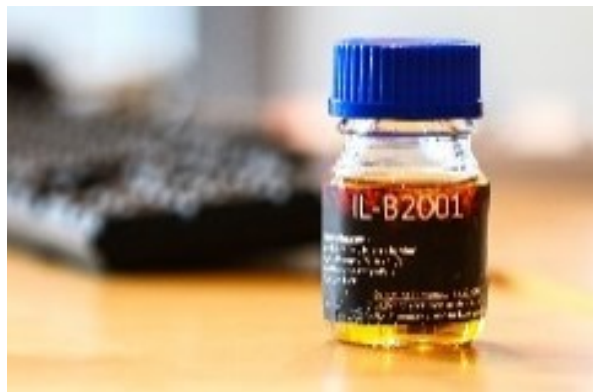
Abbildung 1.7: Wasserfreie Kühllösung - Ionische Flüssigkeit IL-B2001 (Quelle: Mettop GmbH).
