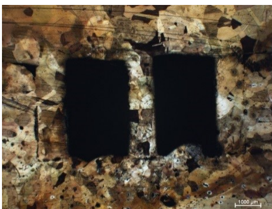
A-08: Angeflorene Schmelze kann die Hohlräume nicht vollständig füllen
