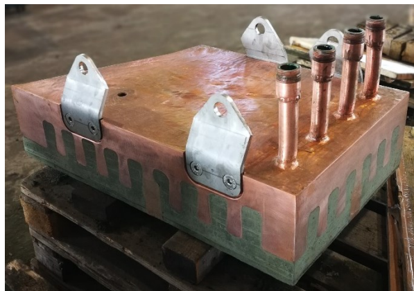
Abbildung 1.1: Kupferkühlelement mit eingegossenen Rohrschlangen und kombinierter Feuerfestzustellung.
