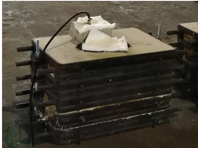
Abbildung 3.13: Formkasten bei der Spülung mit Argon vor dem Abguss - die Fasermatten decken die Anguss- und Speiseröffnung ab um übermäßige Lufteintritt zu verhindern.
