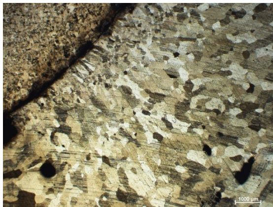
S-01: Feines Korn im Rohr- und Gussmetall und eine deutlich ausgeprägte Grenzschicht Abbildung 4.20: Querschnitt der ersten Probe welche mit aktiver Kühlung abgegossen wurde.
