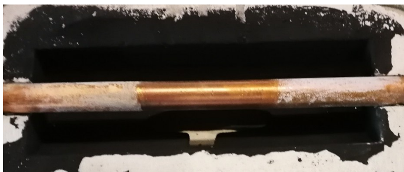
Abbildung 3.9: Rohr in der Sandform vor dem Zusammenfügen der Form. Das Rohr ist in drei Sektionen geteilt, welche mit unterschiedlichen Flussmittel benetzt bzw. blank geschliffen wurden - Linkes Drittel: Castolin; Mitte: metallisch Blanke Oberfläche; Rechtes Drittel: Borax.
