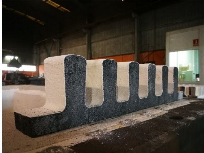
Abbildung 3.14: Teil eines Kernpakets für einen CFM Kühler, welches aus Chromitsand hergestellt wurde und mit Zirkonschicht oberflächlich behandelt ist.
