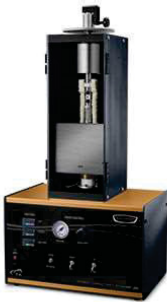
Abbildung 28: Stationäres Wärmeleitfähigkeitsmessgerät DTC 300 [4].
