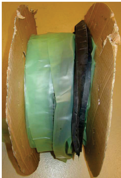
Abbildung 20: Anlieferungsform des SBR Kautschuks.
