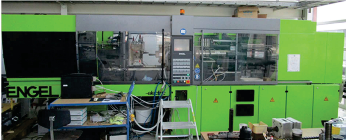
Abbildung 29: Spritzgießmaschine Engel Victory Electric 940/130.
