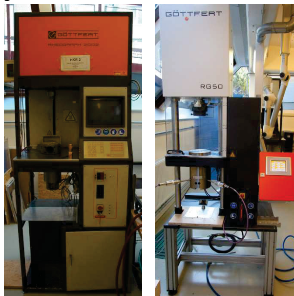
Abbildung 26: Hochdruckkapillarrheometer: (links) RHEOGRAPH 2002 und (rechts) RHEOGRAPH 50.
