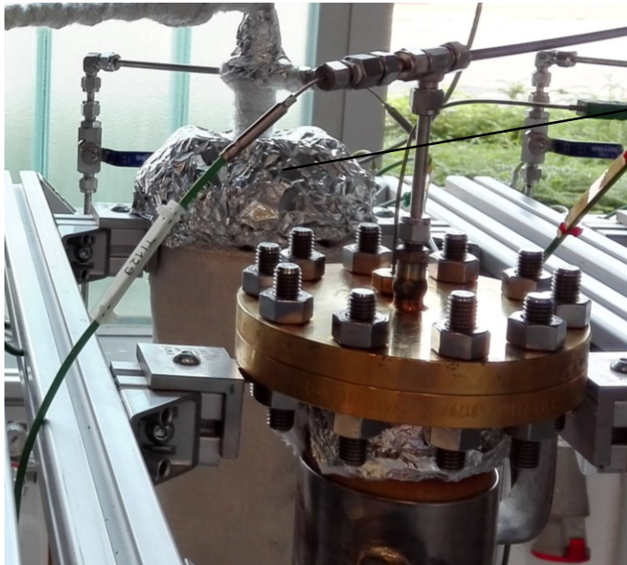
Abbildung 3-10: Druckbehälter mit oberer Flanschisolierung (Druckreaktor nicht isoliert)
