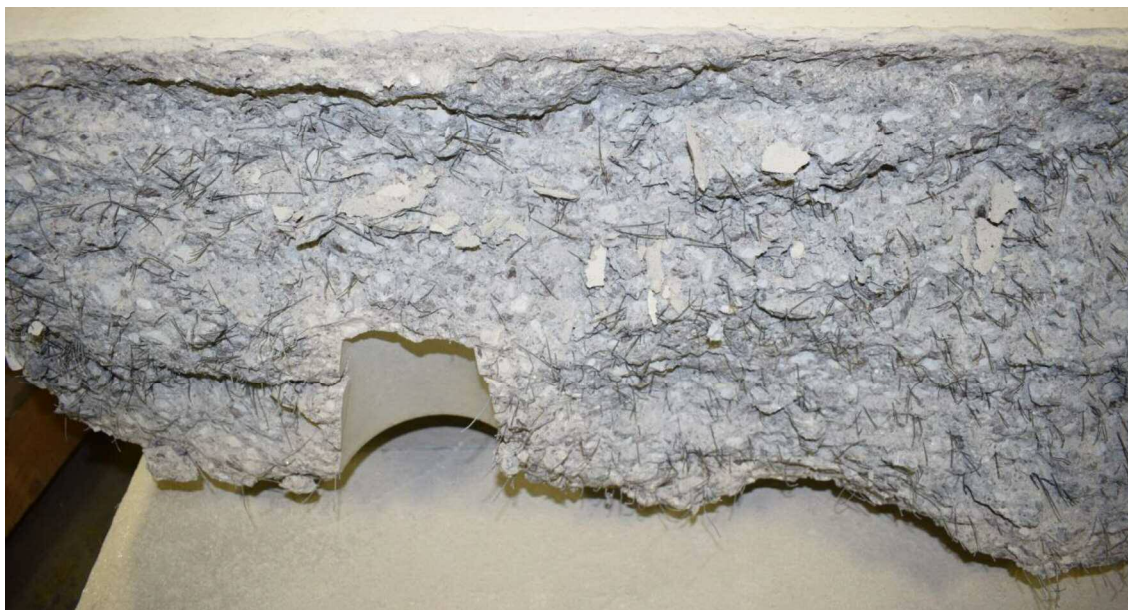
Abbildung 63: Bruchfläche nach Versuchsdurchführung bei Versuch 19
