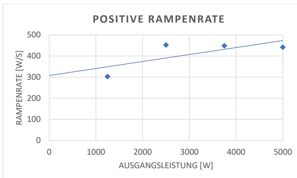
Abbildung 5-14: Positive Rampenrate des Wechselrichters bei Kaltstart
