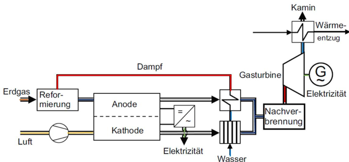
Abbildung 3-9: SOFC System mit gekoppeltem Gaskreislauf [18]
