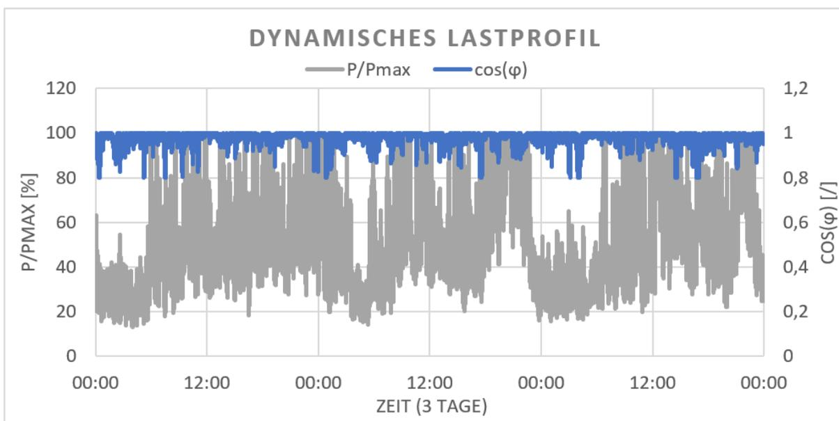
Abbildung 5-5: Dynamisches Lastprofil über 3 Tage/August [51]
