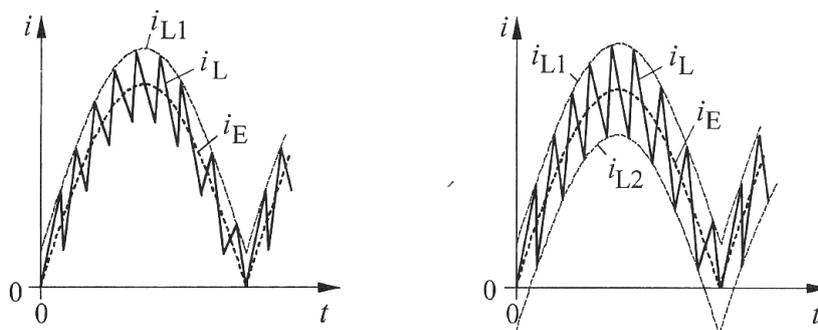
Abbildung 3-24: Pulsbreitensteuerung (links); Zweipunktregelung (rechts) [27]
