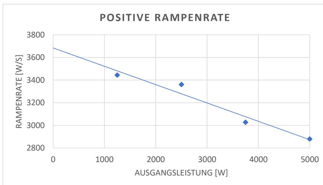
**Abbildung 5-10: Positive Rampenrate des Wechselrichters bei Warmstart**
