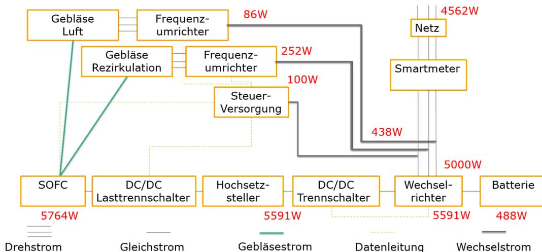
Abbildung 6-8: Notstrom-Inselbetrieb 5 kW Wechselrichter [25, 32, 53, 54, 59–61]
