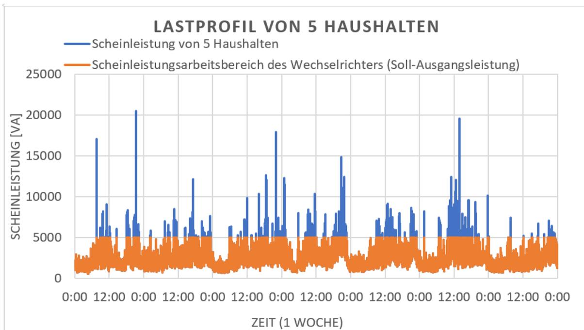
Abbildung 5-4: Elektrisches Lastprofil über eine Woche/August [51]
