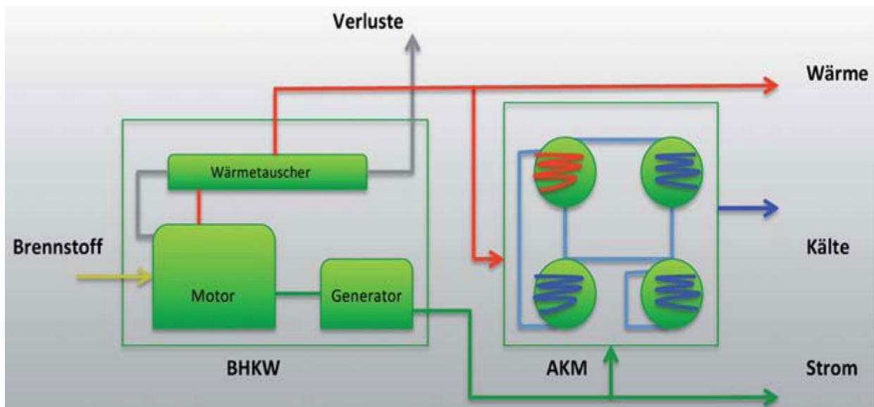
Abbildung 3-12:  $\mu$ KWKK-Anlage [22]
