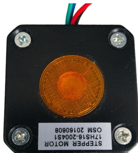
**Abbildung 3-10:** Staubschutzstopfen auf der Motorrückseite
