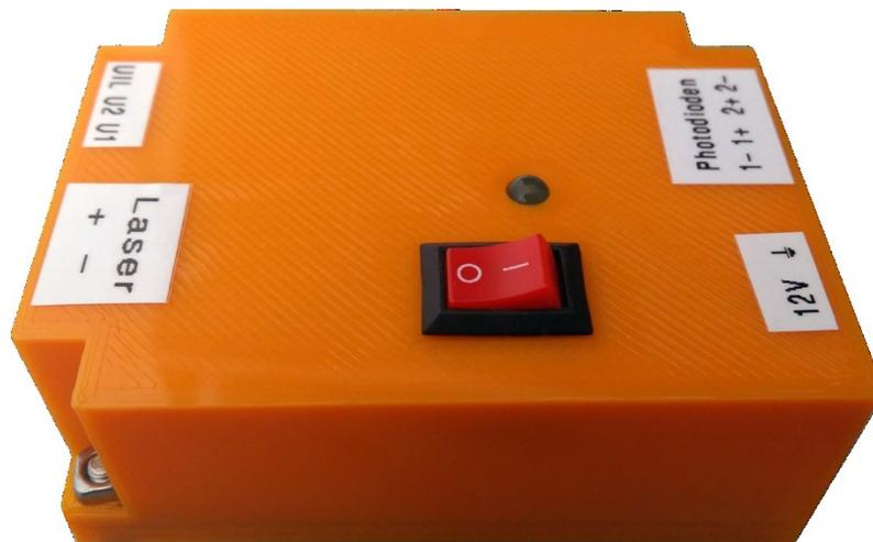
**Abbildung 3-29:** Gehäuse für die Elektronik der Staubkonzentrationsmessung
