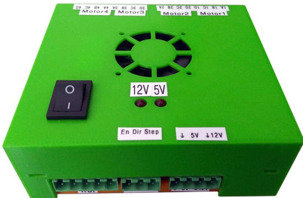
Abbildung 3-18: Im Gehäuse verbaute Motortreiberplatine
