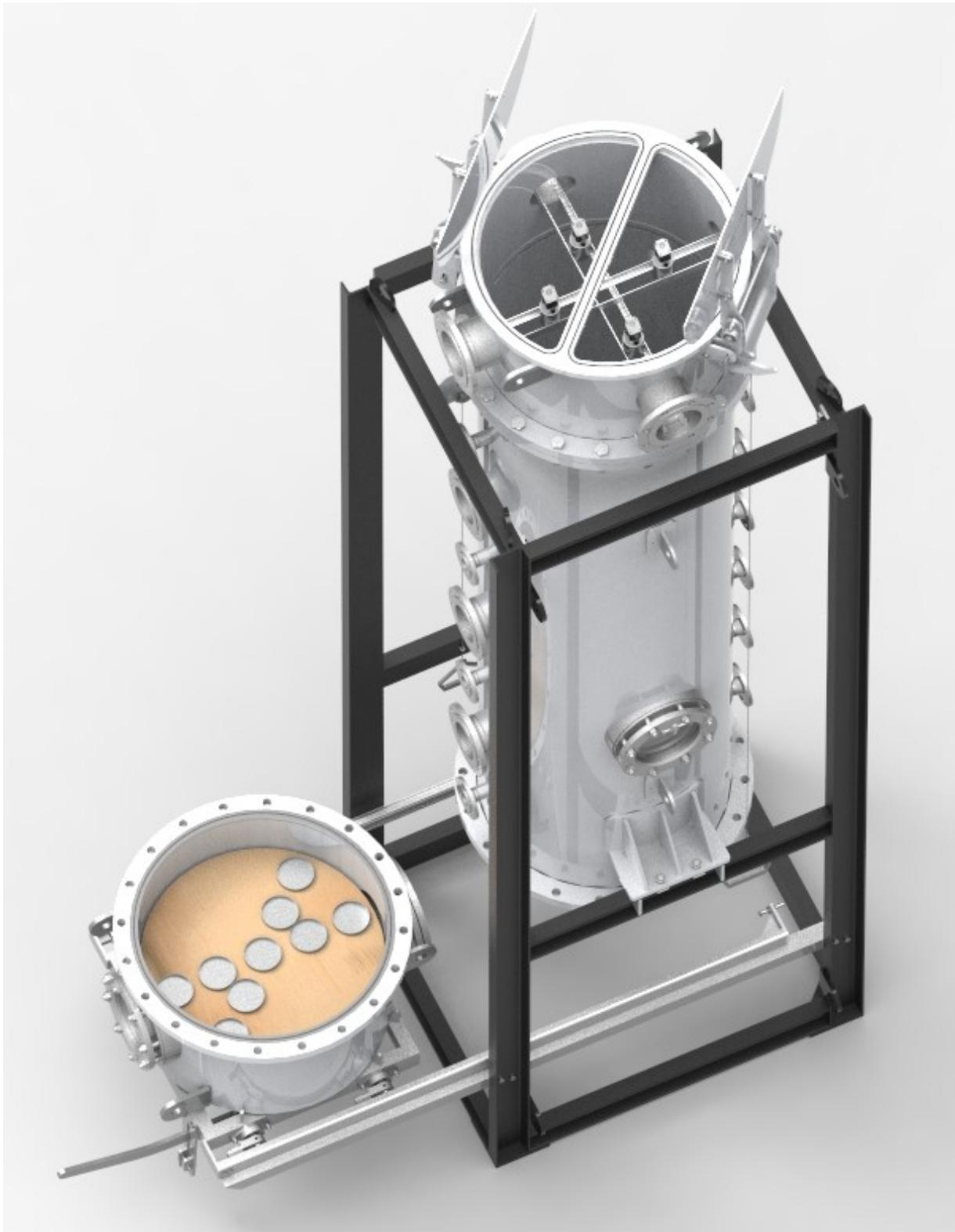
**Abbildung 3-21:** Versuchsaufbau zur Untersuchung der Staubverteilung
