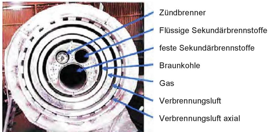
Abbildung 45 - Mehrstoffbrenner für Drehrohrofenanlagen; nach [52]
