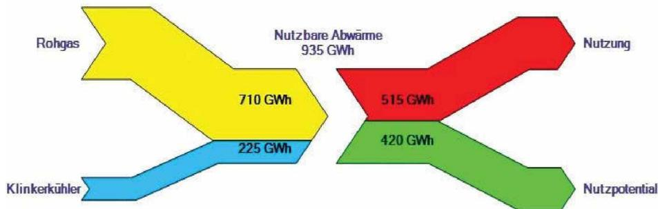
Abbildung 31 - Nutzbare Abwärmepotentiale der österreichischen Zementindustrie im Jahr 2007, [51]
