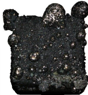
Abbildung 47: Metallabscheidung am Graphitwürfel.
