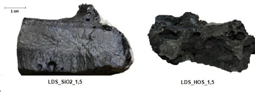
Abbildung 46: Vergleich der Proben, hergestellt mit Quarzsand und Hochofenschlacke
