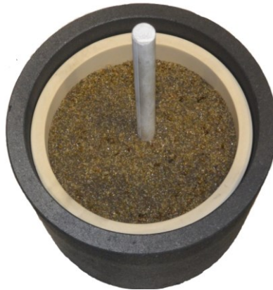
Abbildung 18: Ring-in-Ring-Konzept für die Schmelzversuche
