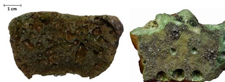
Abbildung 48: Vergleich von Abstich (links) und Restschlacke (rechts)
