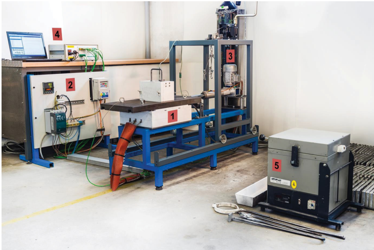
Abbildung 3-1: Übersicht der Versuchsgießanlage mit Gießeinheit (1), Steuereinheit (2), elektrischem Spindelantrieb (3), Datenaufzeichnung (4) und Schmelzeinheit (5).
