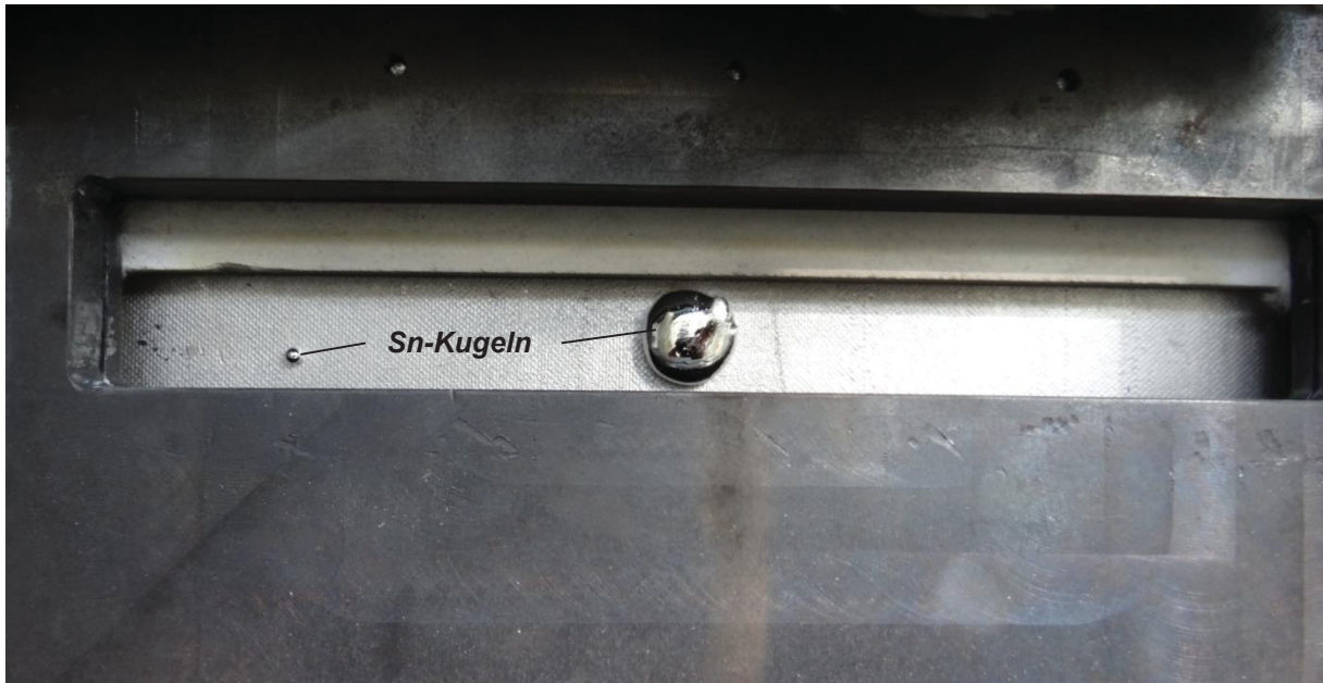
Abbildung 5-53: Sn-Ausscheidungen an der Substratoberfläche beim Erhitzen der Substratplatte in der NanoCastPlant.
