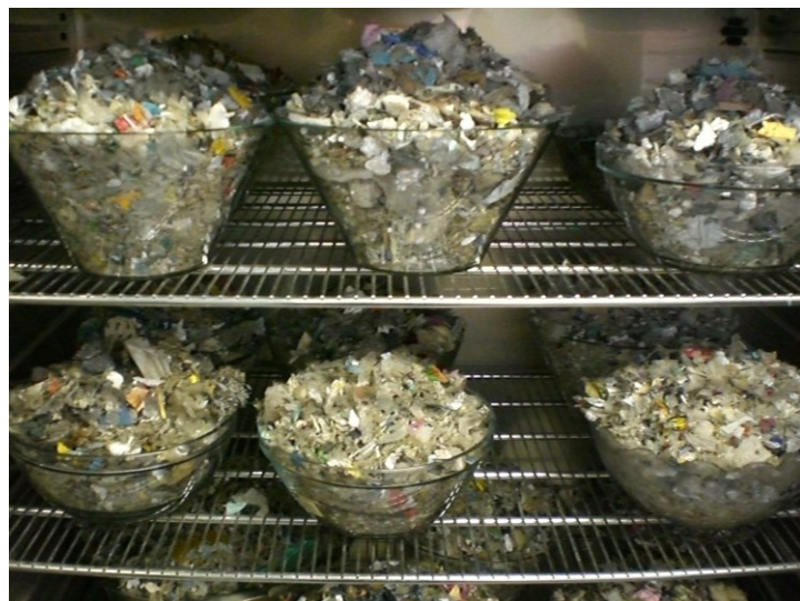
Abbildung 8: Trockenschrank und Proben bei der Trocknung
