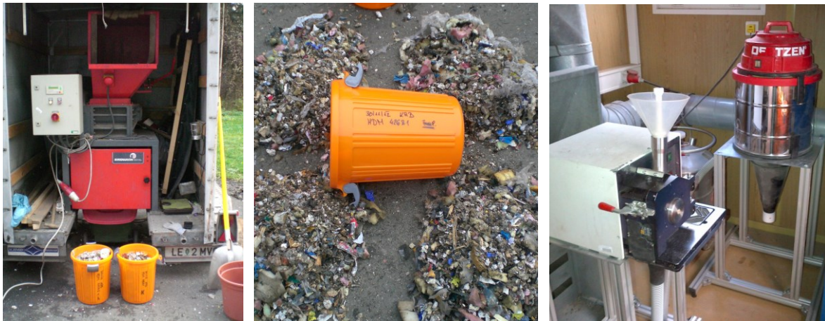
Abbildung 6: Doppelwellenzerkleinerer – Probenverjüngung – Schneidmühle
