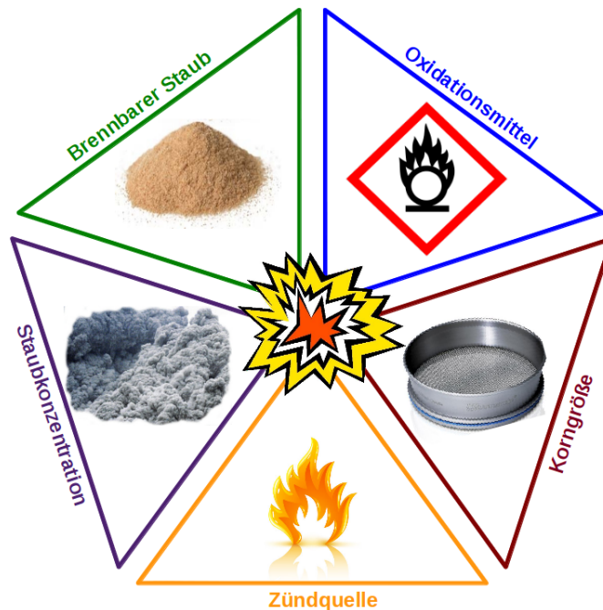
Abbildung 1.2: Voraussetzungen für die Entstehung einer Staubexplosion
