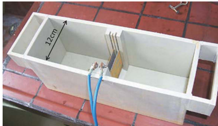
Abbildung 3.1 – Experimentelle elektrolytische Zelle zur einseitigen und beidseitigen Schichtabscheidung. Die Zelle ist für Proben mit den Abmessungen 84 mm × 120 mm geeignet, wobei eine Fläche von etwa 80 mm × 80 mm beschichtet wird. Die Zelle fasst ein Elektrolytvolumen von etwa 5 l.
