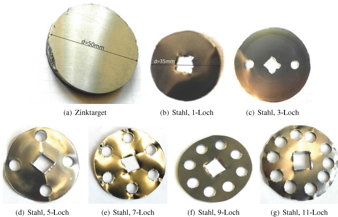
Abbildung A.10 – Verschiedene verwendete Sputtertargets. Abbildung (a) zeigt das Zinktarget, eine Scheibe aus hochreinem Zink mit einem Durchmesser von 50 mm und einer Dicke von 5 mm. Die Abbildungen (b) bis (g) zeigen die Stahlfolien mit unterschiedlicher Lochanzahl, welche auf das Zinktarget gelegt wurden. Die Folienscheiben weisen einen Durchmesser von 35 mm bei einer Dicke von 0,1 mm auf.
