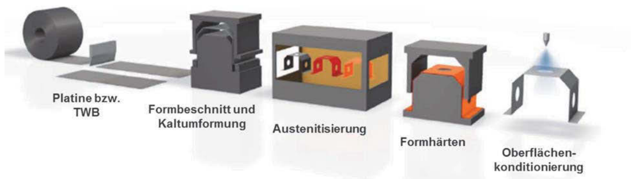
Abbildung 2.2 – Indirektes Presshärten ermöglicht dank mehrerer Umformschritte auch komplexe Geometrien und werkzeugschonenden Zuschnitt.
